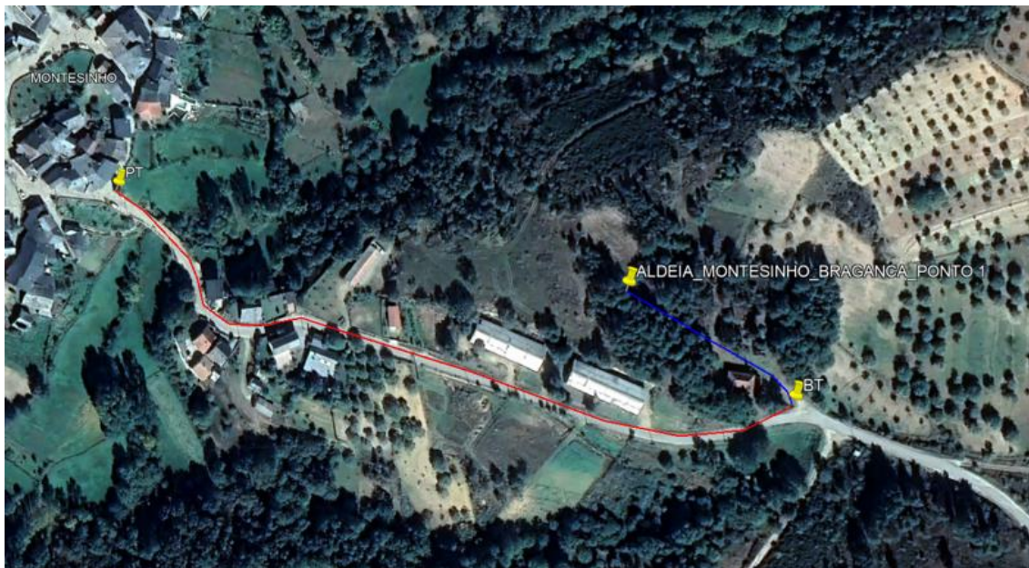
Figura 21 - Ligação à rede de energia de uma estação de telecomunicações GBT
