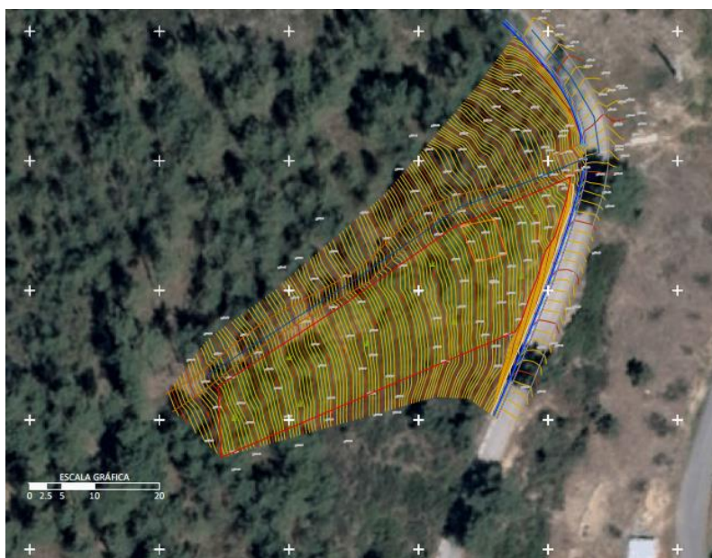
Figura 20 - Levantamento topográfico de uma estação de telecomunicações
