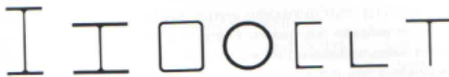
Figura 29- Geometrias de perfis laminados a quente (Simões 2014)
