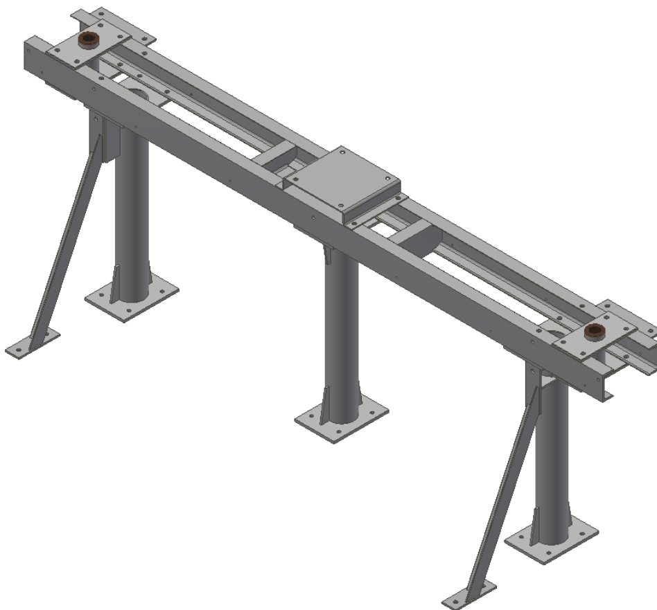
Figura 119- Base de assentamento da estrutura
