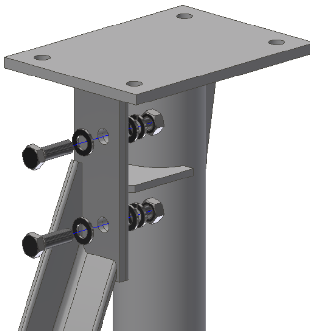
Figura 175- Etapa 2: Montagem dos travamentos nos pilares da base de assentamento
