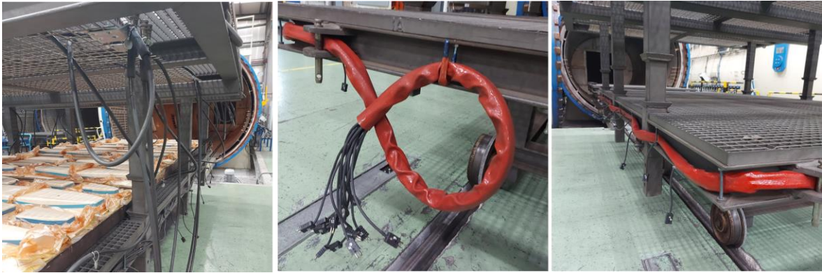
Figura 25 - Fixação das mangueiras nos carros da AU e das extensões dos termopares com manga térmica
