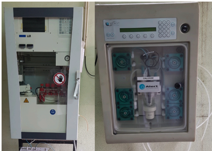
Figura 3.8 - Analisadores utilizados, analisador de CQO e de cloretos da esquerda para a direita, respetivamente.
