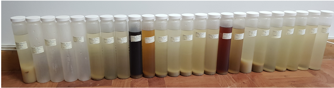
Figura 4.5 - Amostras simples recolhidas na EE, com auxílio a um amostrador automático, entre as 9h do dia 13 de maio de 2020 e as 8h do dia seguinte.
