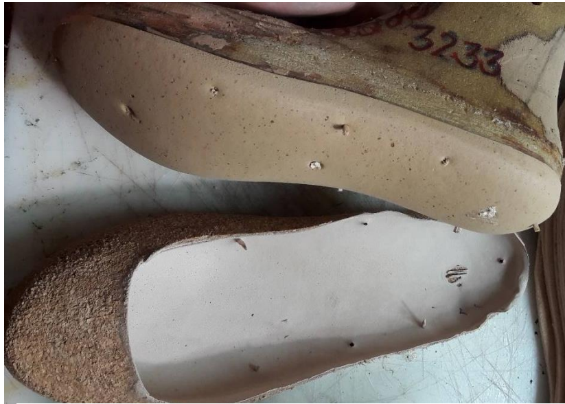
Figura 30 - Exemplo pregos não sinalizados
