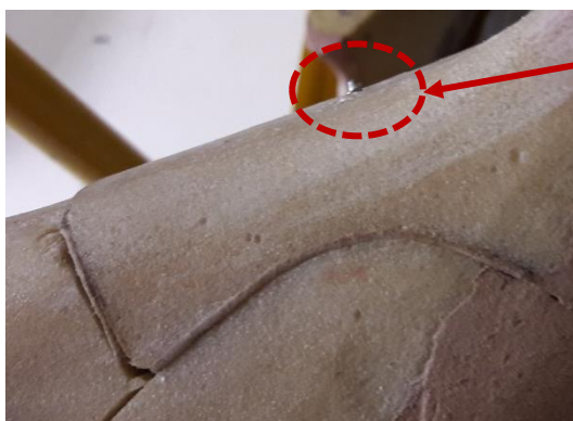
Figura 31 - Exemplo de forma com parafuso mal posicionado
