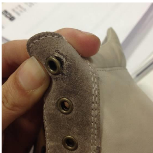
Figura 32 - Danificado nas orelhas a)
