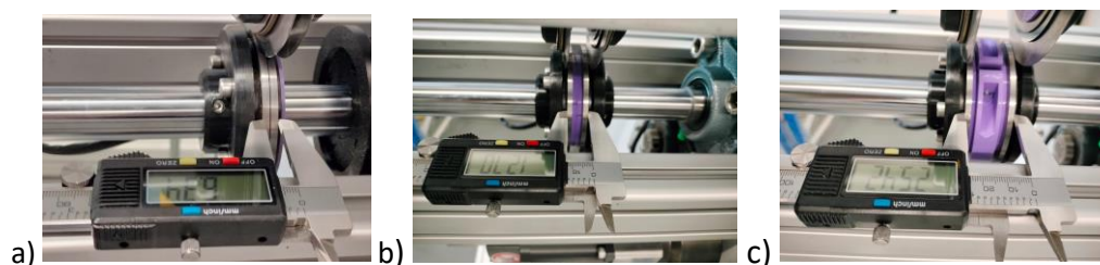
Figura 115 - Medições entre as contrafacas com paquímetro: a) configuração \frac{1}{4} ''; b) configuração \frac{1}{2} ''; c) configuração 1''.
