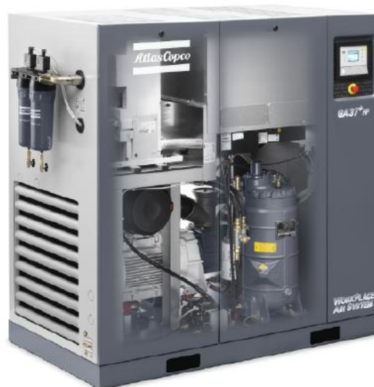
Figura 3. 6 Compressor de parafuso Atlas Copco.
