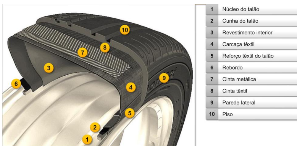
Figura 2.1 - Representação esquemática das camadas que constituem um pneu [14].
