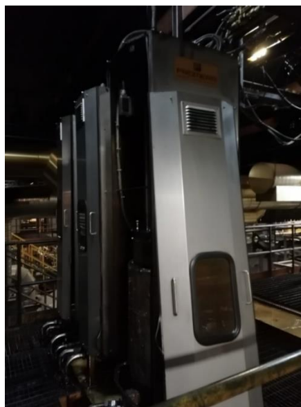
Figura 3.17 - Cilindro volumétrico de doseamento de óleos e silanos
