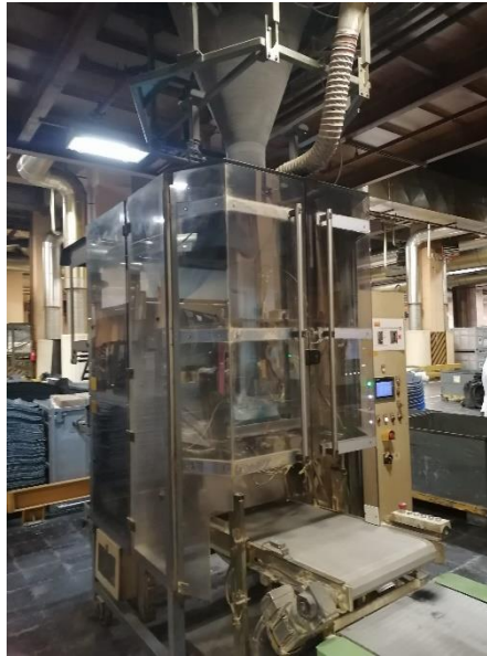
Figura 3.16 - Sistema de doseamento automático de pigmentos
