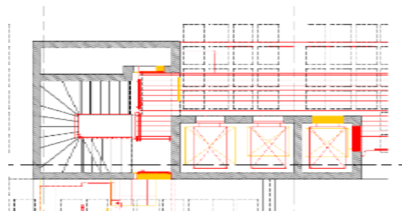
Figura 3.9 - Intervenção na parede do elevador (OMATAPALO - Engenharia e Construção, 2022)
