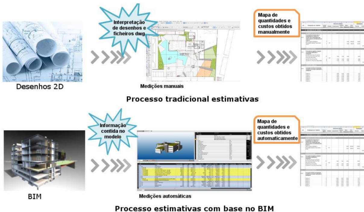
Figura 3.35 - Capacidade do BIM em obter mapas de quantidades automáticos em oposição ao método tradicional de medições (Poças, 2015)
