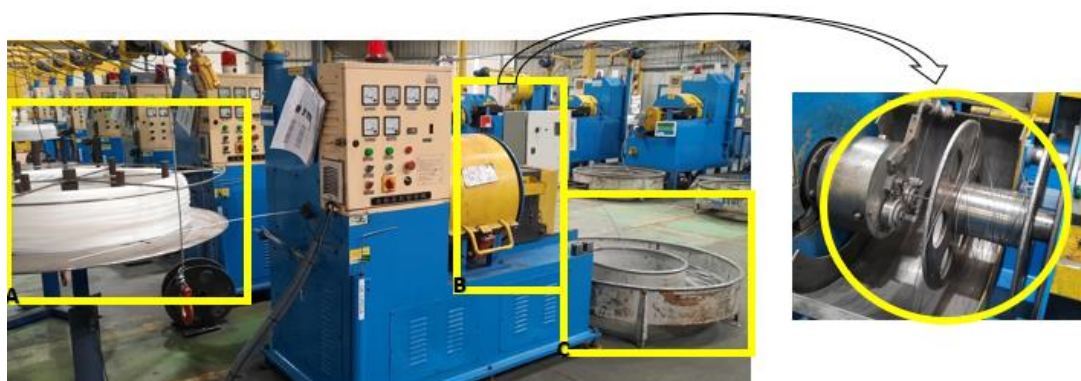
Legenda: A – Posicionamento da bobine do tubo interior B – Posicionamento da bobine de arame e onde ocorre a laminagem final D – Posicionamento da bobine do produto final (espiral laminada)
