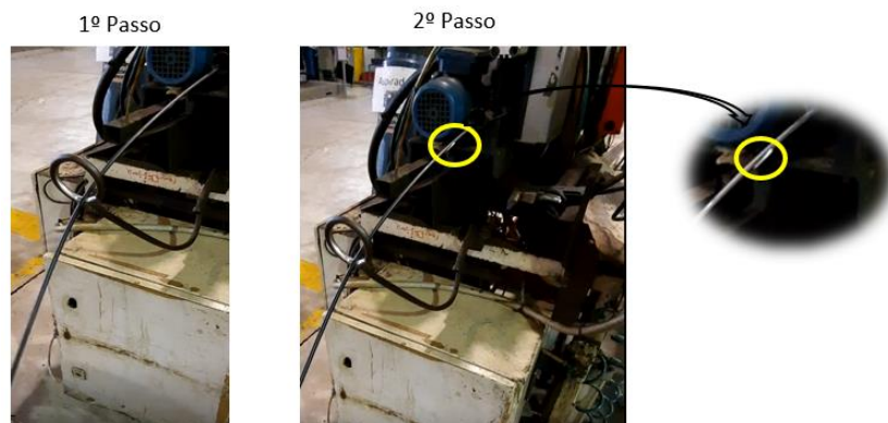
Figura 43 - Torção no arame, no fabrico nas máquinas de corte de espiral
