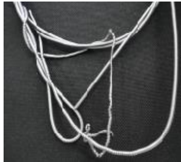
Figura 42 – Torção no arame, no fabrico nas máquinas chinesas
