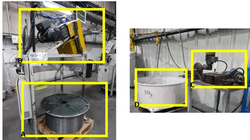
Legenda: A – Posicionamento da bobine de arame B – Laminagem final e encadeamento do arame C – Posto de trabalho onde se realiza as uniões da espiral D - Posicionamento da bobine do produto final (espiral laminada)
