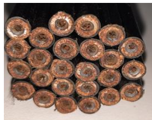
Figura 50 – Espiral laminada oxidada
