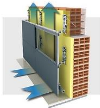
Figura 9-Esquema do fluxo de calor numa fachada ventilada [60]
