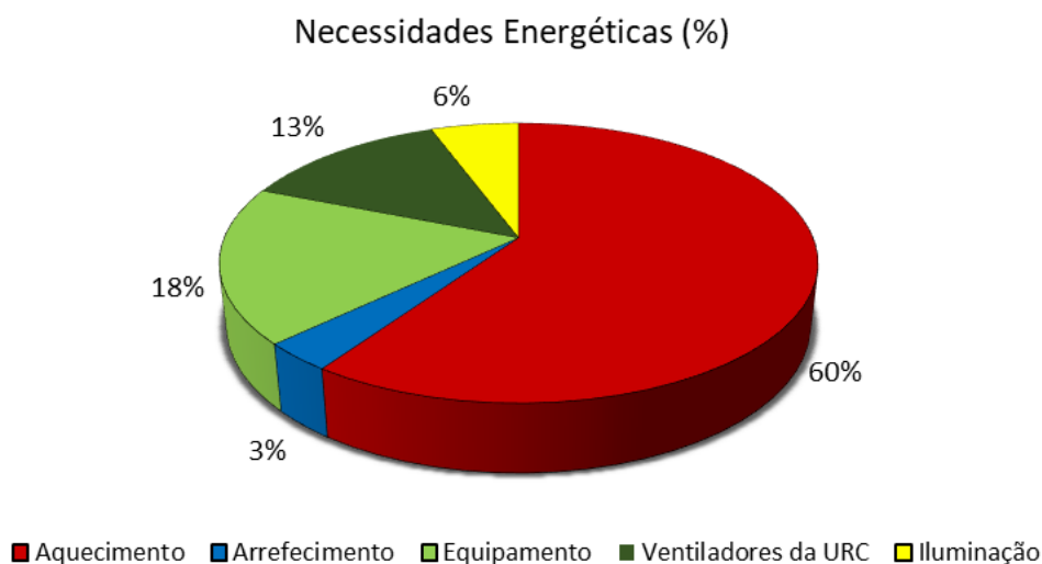
Figura 43- Balanço energético do caso com implementação URC
