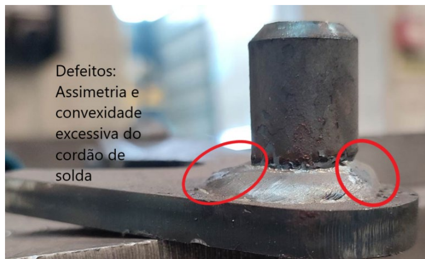
Figura 45 - Assimetria do cordão (à esquerda). Excesso de material (à direita)
