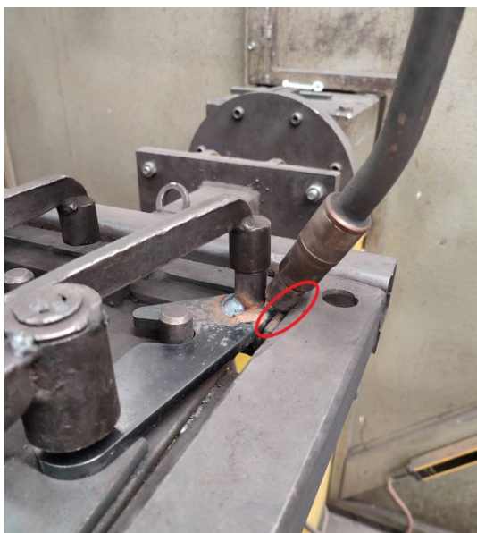
Figura 48 - Restrição identificada no gabarit
