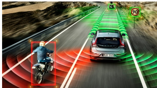
Figura 2.3: Detecção de obstáculos com sensor radar.
