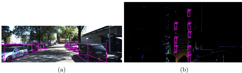
Figura 2.18: Imagem a) com plano frontal convertida ao b) bird's eye view [34]
