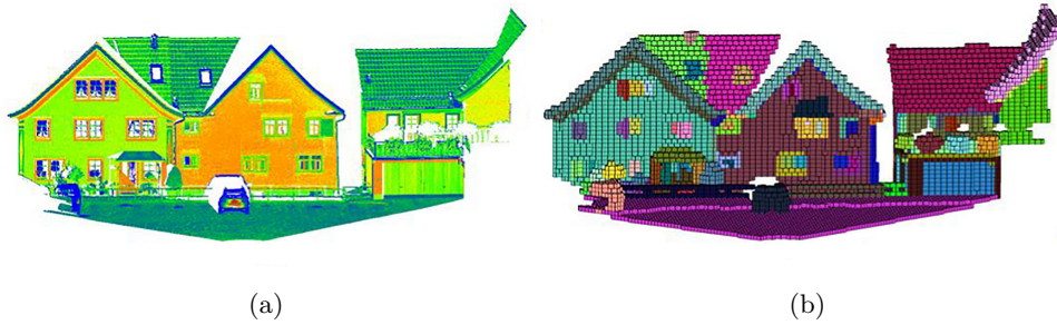
Figura 2.15: Diferença entre a) point cloud original e b) renderizada em Voxels [30].
