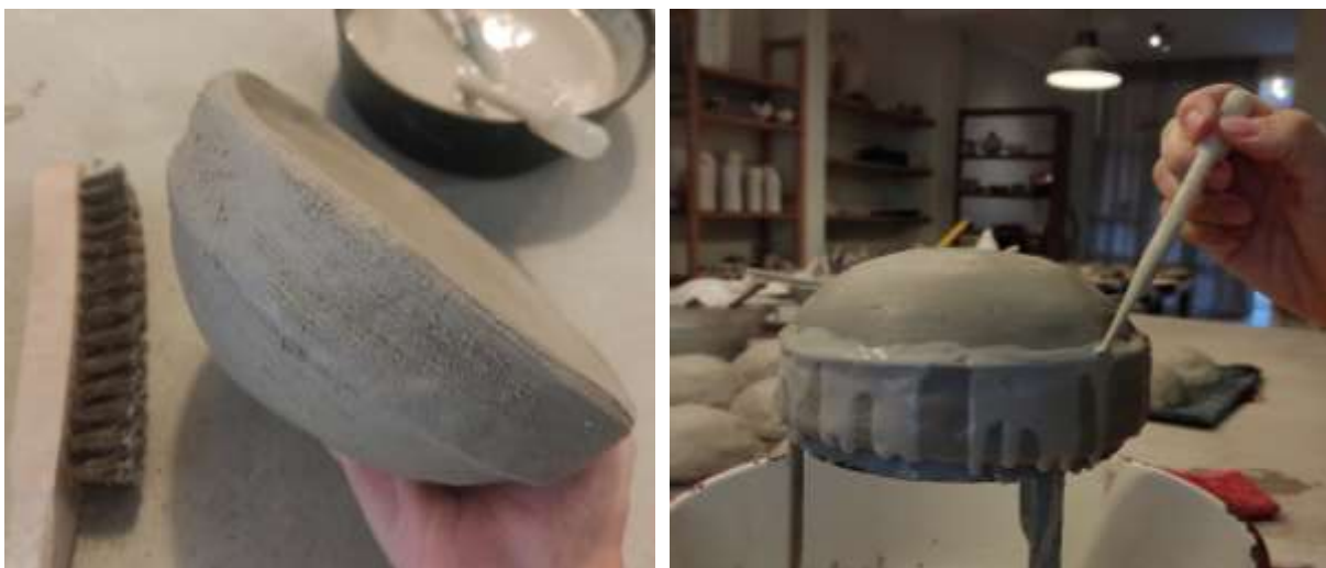
Figura 65: Peça texturizada com a escova de metal
