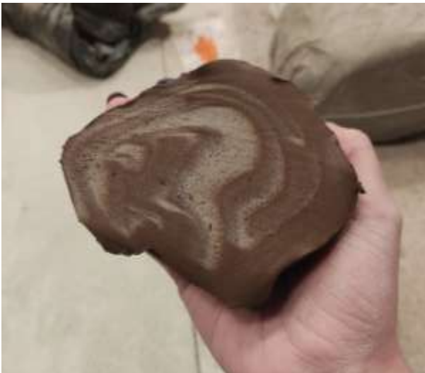
Figura 95: Efeito mármore adquirido através da mistura das pastas cerâmicas
