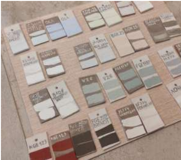
Figura 123: Amostras vidradas antes da 2ª fornada
