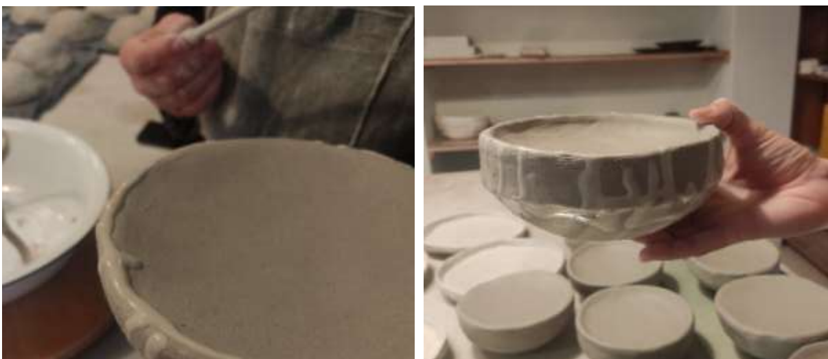
Figura 67: Colocação de barbotina nas taças
