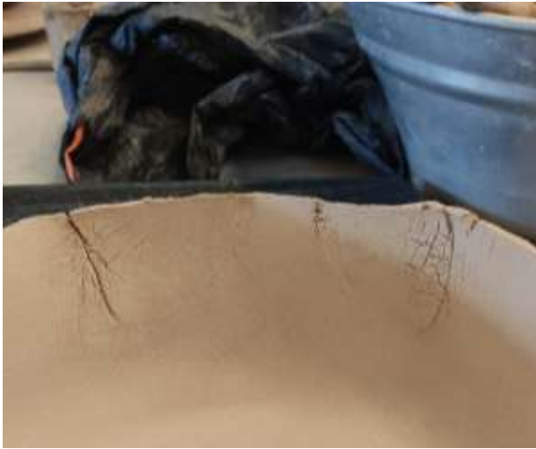
Figura 217: Fissuras na peça de porcelana
