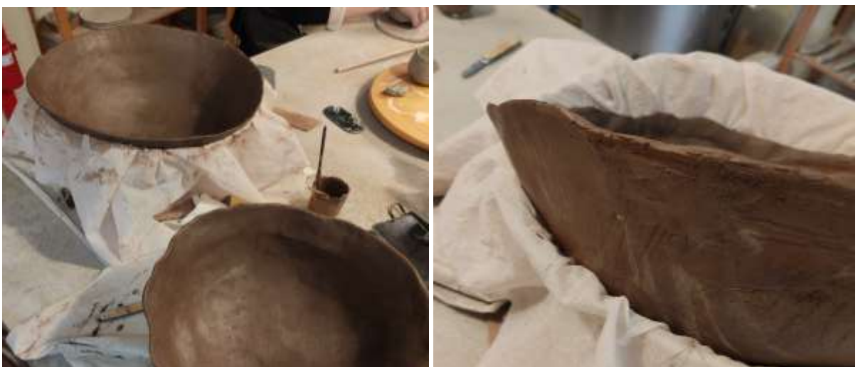
Figura 101: Peças a secar dentro dos moldes
