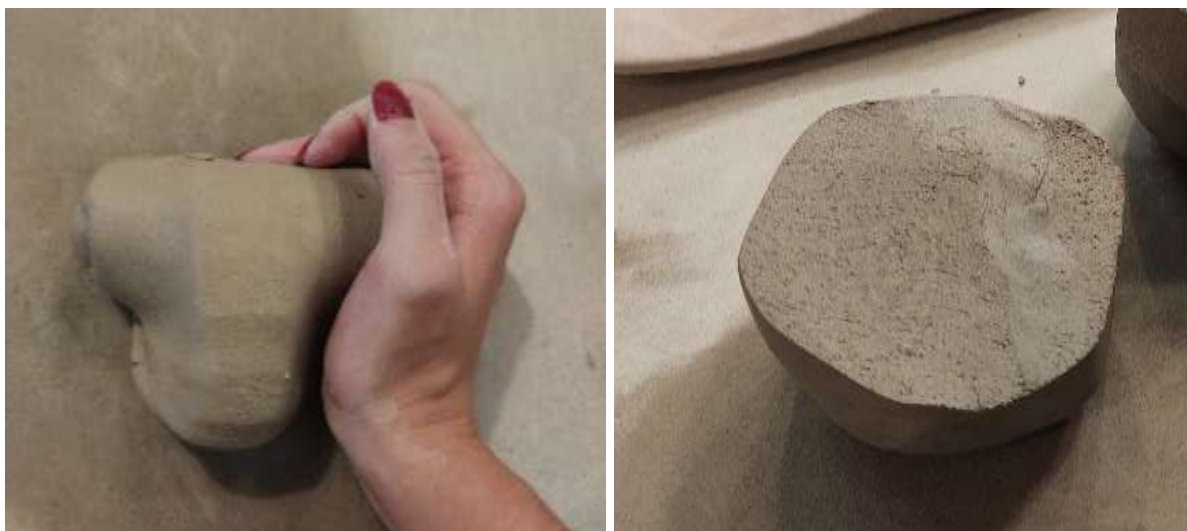
Figura 41: Reciclagem da pasta cerâmica através da técnica de amassar em “T”
