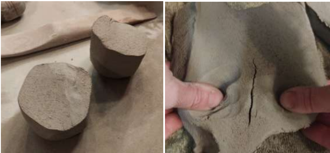
Figura 31: Verificação de bolhas na pasta cerâmica
