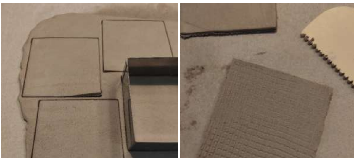
Figura 35: Recorte dos azulejos através de uma forma metálica
