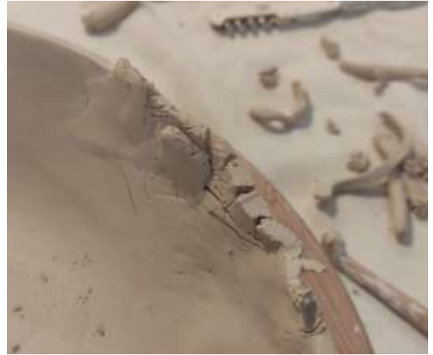
Figura 217: Fissuras na peça de porcelana
