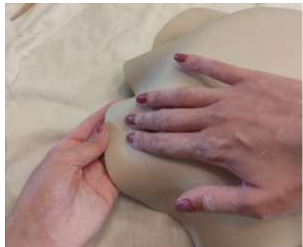
Figura 157: Colocação da lastra de porcelana sob o molde
