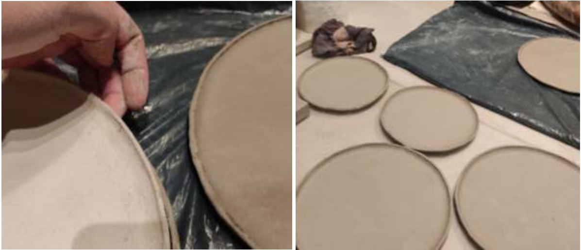
Figura 49: Remoção do molde do prato
