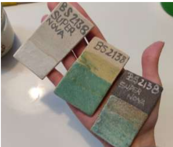
Figura 125: Amostra do mesmo vidro em diferentes pastas cerâmicas
