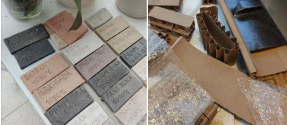
Figura 27: Amostras de diferentes pastas cerâmicas com a temperatura associada
