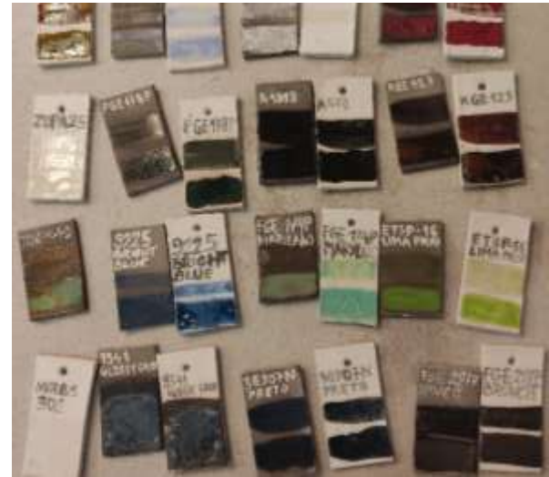
Figura 123: Amostras vidradas antes da 2ª fornada
