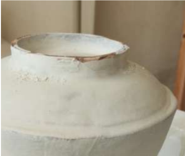
Figura 207: Vidragem do exterior da malga em PRAI com PRNF
