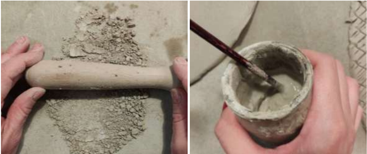
Figura 45: Pasta cerâmica seca e moída pronta a ser adicionada na barbotina
