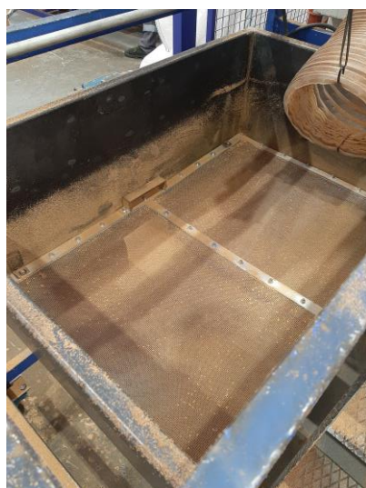
Figura 26 - Rede e caixa do peneiro alterado
