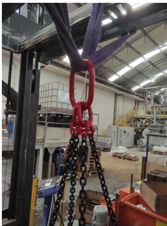
Figura 68 - Linga de quatro pontos presa pela cinta nos garfos do stacker
