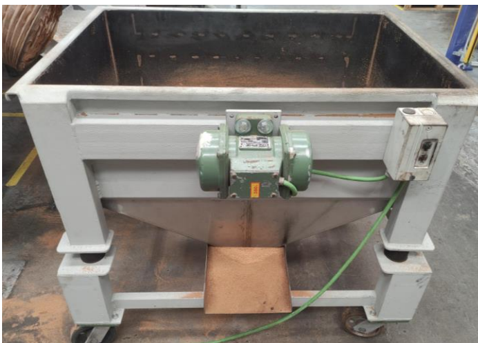
Figura 29 - Motor Vibratório do novo peneiro
