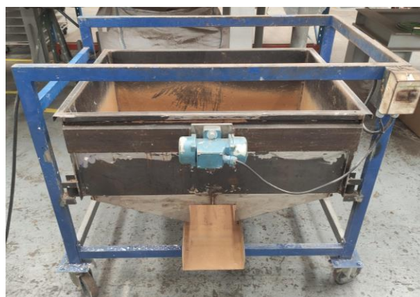
Figura 27 - Motor Vibratório do peneiro alterado
