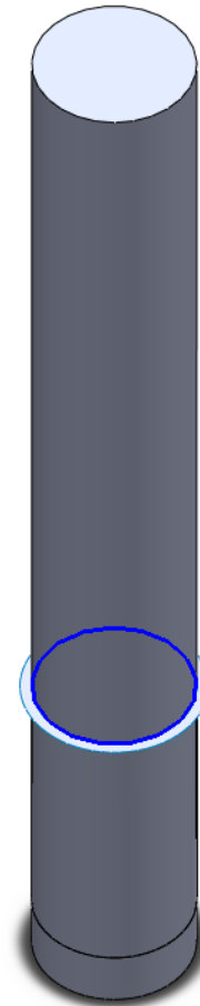
Figura 79 - Peça com os novos corpos sólidos criados
