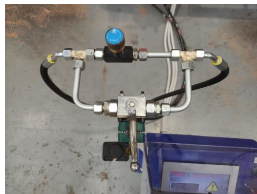
Figura 46 - Mecanismo de redução de caudal fechado
