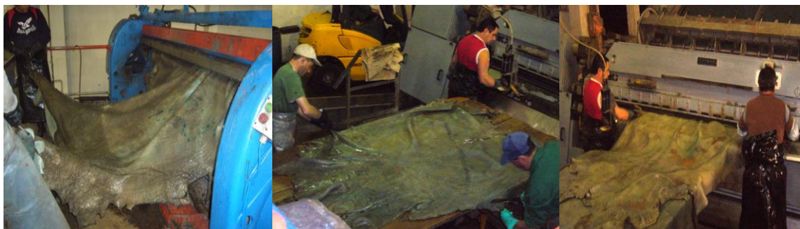
Figura 1.3 - Processo da descarna usado na empresa Curtumes Aveneda, Lda.
