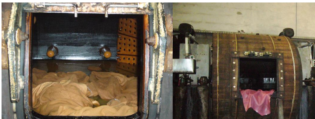
Figura 1.7 - Processo de recurtume e tingimento efectuado em fulões
