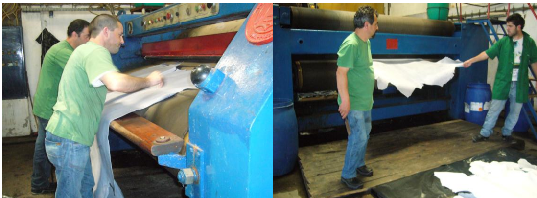
Figura 1.5 - Operação de escorrimento efectuado na empresa Curtumes Aveneda, Lda.
