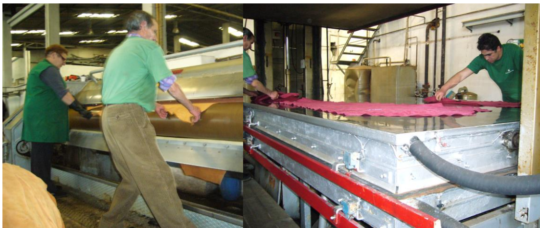
Figura 1.8 - Processos de escorrimento e alisamento e secagem efectuados na empresa Curtumes Aveneda, Lda.
