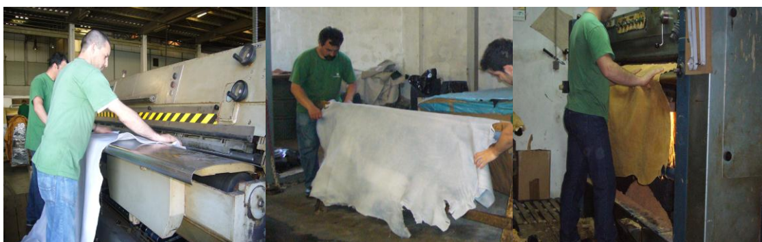
Figura 1.6 - Processos de divisão e rebaixamento na empresa Curtumes Aveneda, Lda.
