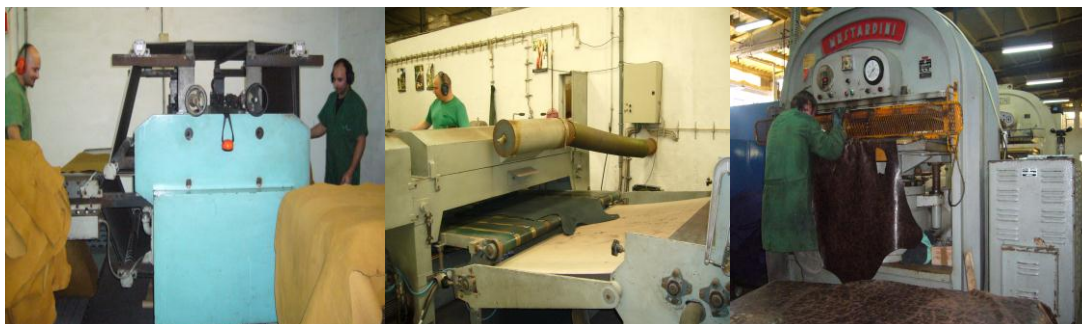
Figura 1.9 - Processos de amaciamento, lixagem e prensagem na empresa Curtumes Aveneda, Lda.
