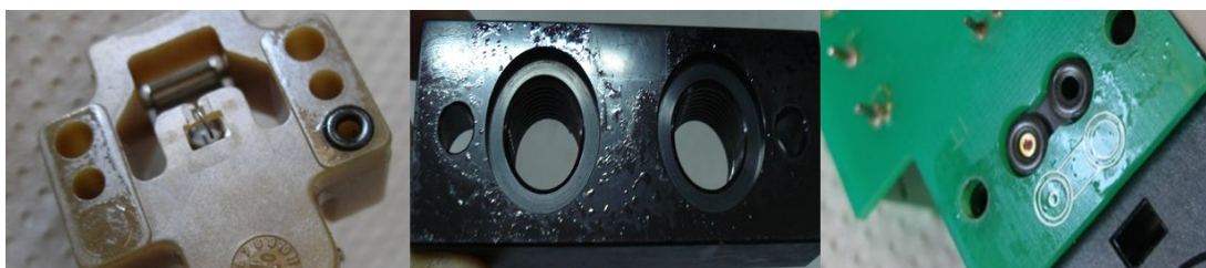
Figura 75 - Óleo detectado no interior de alguns posicionadores. Fonte: SAMSON
