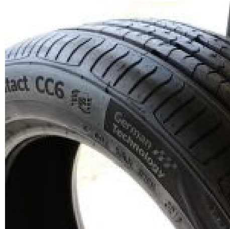
Figura 34 - Pneu no seu formato final, após a vulcanização. Fonte: All Cars Channel.
