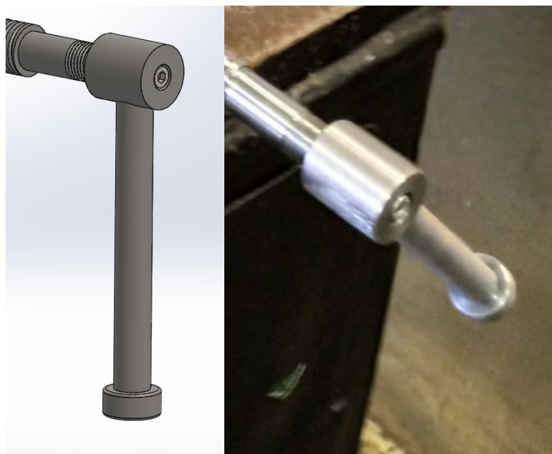
Figura 114 - Acoplamento final entre o manipulador e o fuso.
