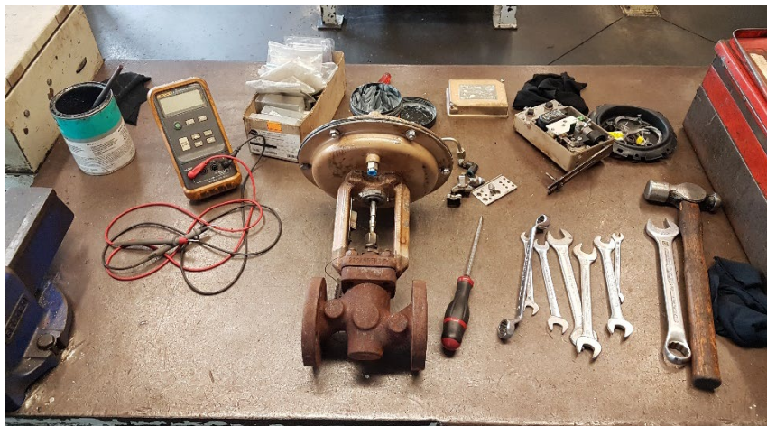
Figura 73 - Ferramentas necessárias à reparação de uma válvula proporcional.
