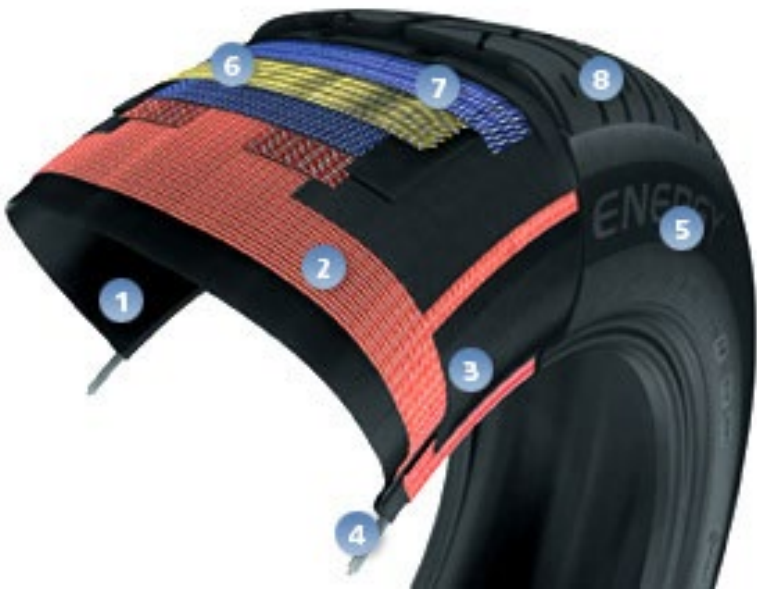
Figura 21 – Diferentes camadas de um pneu. Fonte: Michelin.
