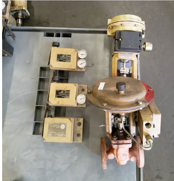
Figura 81 - Válvulas completas e posicionadores, na paleta de material reparado, prontos para seguir para armazém.
