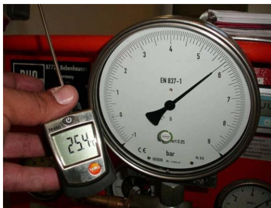
Figura 23- Indicação da pressão do compartimento através de um monómetro com o registo da temperatura ambiente.
