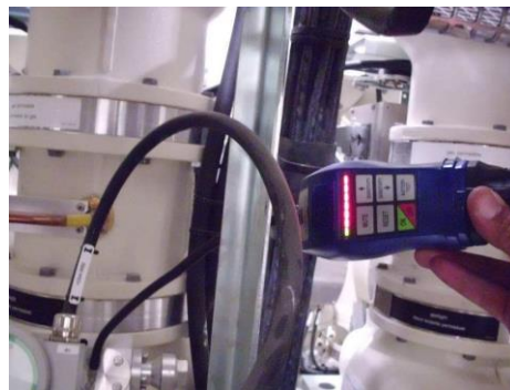
Figura 21- Detetor de fugas de SF 6 digital.
