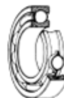
Figura 2: Rolamentos Fixos de Uma Carreira de Esferas [11]
