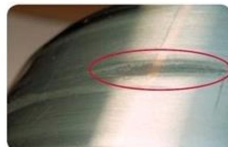
Figura 24: Desgaste adesivo na pista do anel interno de um rolamento de rolos cilíndricos ref.[SKF/2012]
