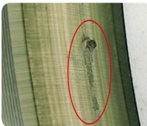
Figura 16: Fadiga superficial inicial no anel externo de um rolamento autocompensador de rolos ref.[SKF/2012]
