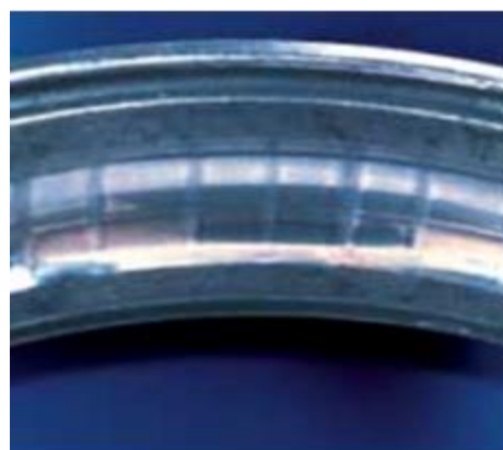
Figura 31: Falso efeito brinell em um rolamento de esfera [25]
