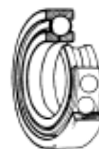
Figura 6: Rolamentos de Esferas de Quatro Pontos de Contacto [11]
