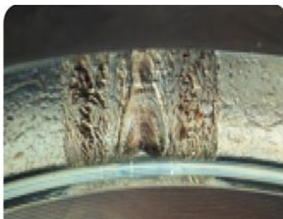
Figura 15: Fadiga superficial inicial em uma pista do anel externo de um rolamento ref.[SKF/2012]
