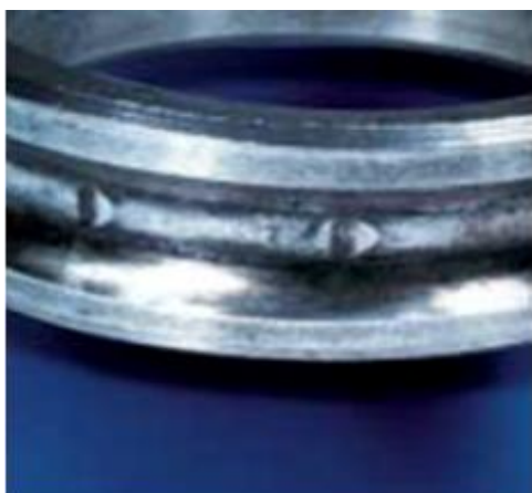
Figura 26: Gripagem com incrustação das esferas [25]
