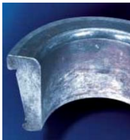
Figura 35: Corrosão de contato no diâmetro interno e na face de apoio [25]
