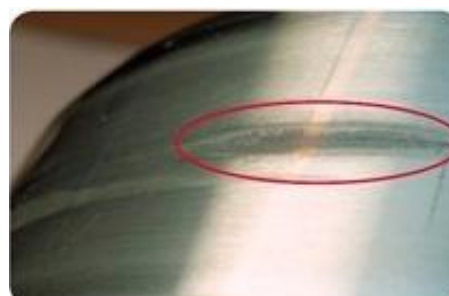
Figura 19: Desgaste abrasivo na pista do anel interno de um rolamento de rolos cilíndricos ref.[SKF/2012]
