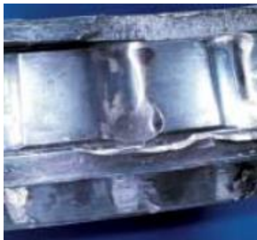
Figura 27: Gripagem de um rolamento autocompressor de rolos incrustação de rolos e rutura de borda [25]
