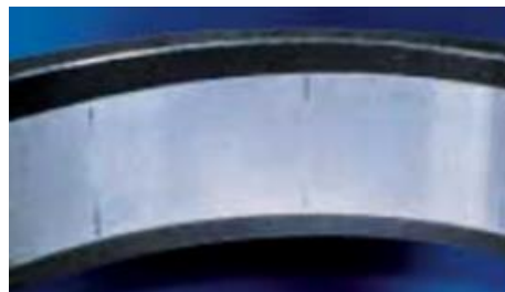
Figura 29: Arrancamento de material na pista na pista de um anel externo [25]
