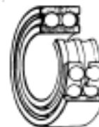
Figura 5: Rolamentos de Duas Carreiras de Esferas de Contacto Angular [11]
