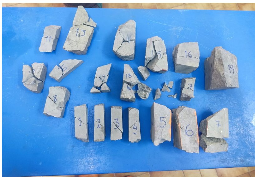
Figura 3.27: Amostras após o ensaio de carga pontual.
