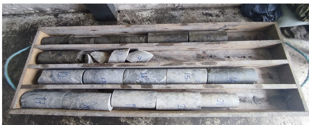
Figura 3.24: Carotes cortados para ensaio à compressão uniaxial em prensa (Cortesia da ALMINA).
