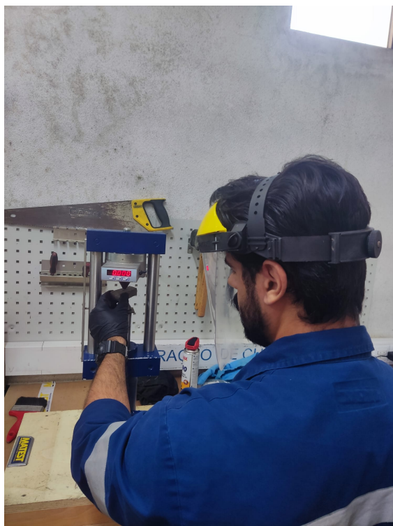
Figura 3.26: Exemplificação do ensaio de carga pontual ( Point-Load Test ).
