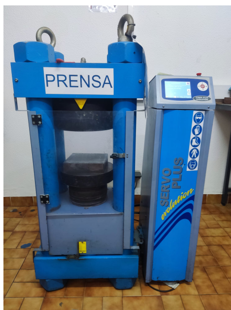
Figura 2.3: Prensa hidráulica para ensaio de compressão uniaxial em provete cilíndrico (cortesia ALMINA).
