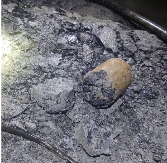
Figura 3.20: Caroteamento abortado em Stockwork : à direita o betão projetado; à esquerda o material argiloso.
