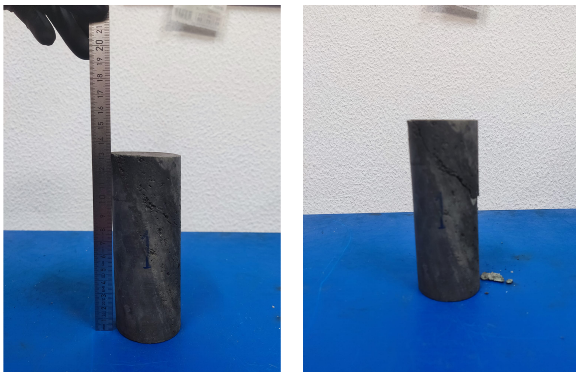
(a) Amostra nº 1 de sulfuretos maciços antes do ensaio de compressão uniaxial.
