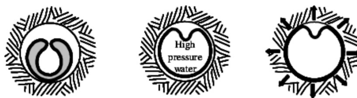
Figura 2.17: Ilustração do processo de expansão do prego Swellex (segundo Li & Håkansson, 1999).
