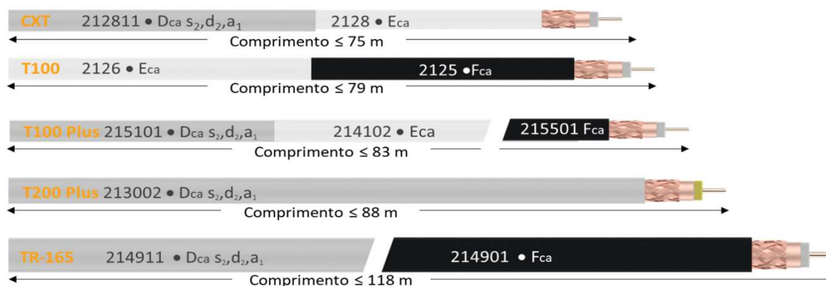
Figura 1 - Comprimentos máximos do Cabo Coaxial em função dos limites de atenuação e Slope do ITED4
