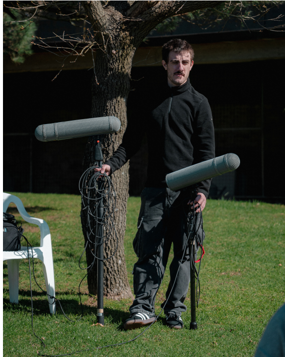
Figura 3.4: Microfones com proteção de vento Rycote, para captação em exterior.
