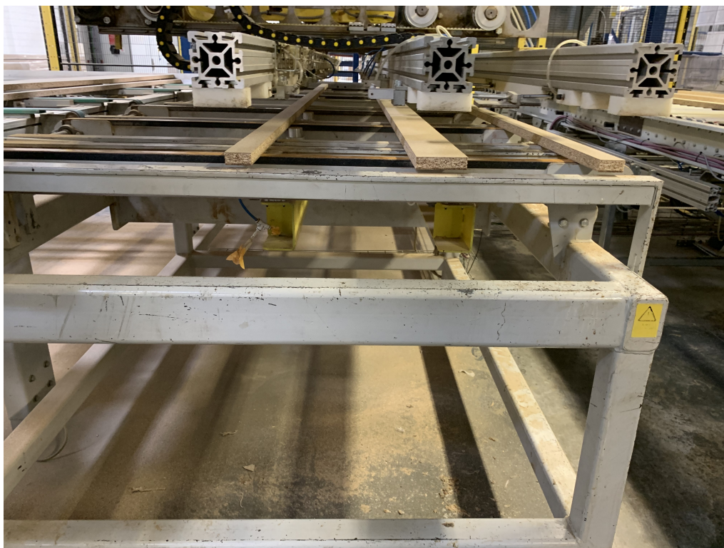
Figura 4.6: Ripas na zona de espera na Posição 43 enquanto aguarda o ciclo da Posição 8.
