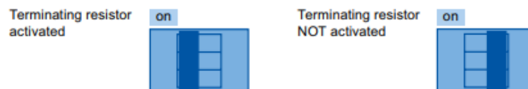
Figura G.3: Ativação da resistência de fim de linha nos repetidores RS-485 [20].
