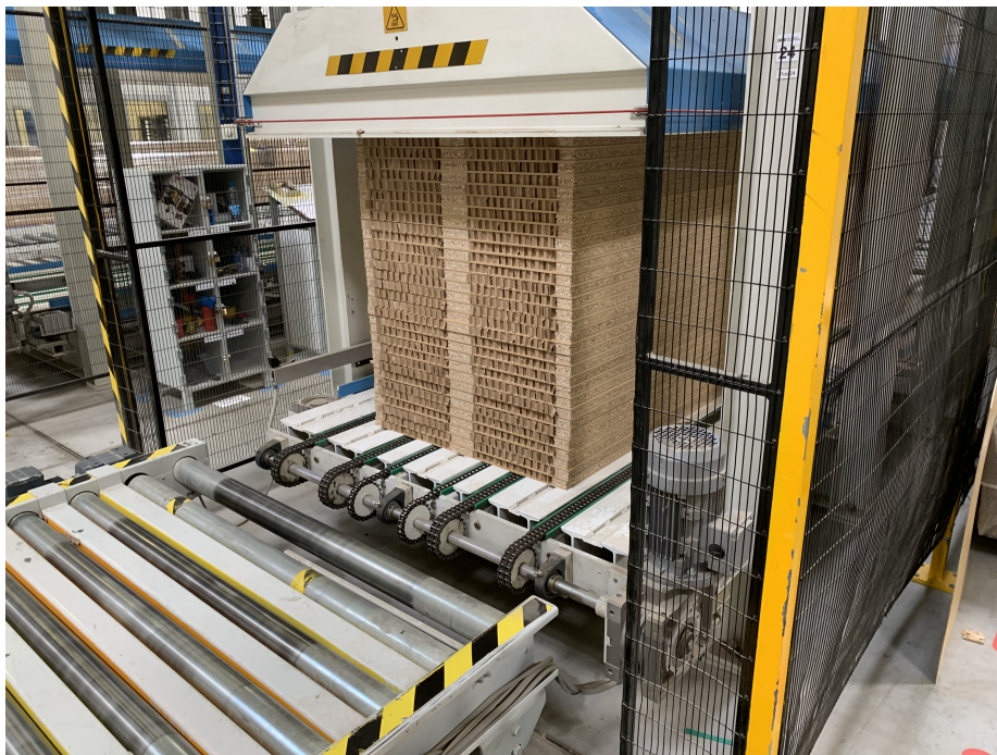
Figura 4.11: Produtos no processo de compressão na prensa da Posição 24b.
