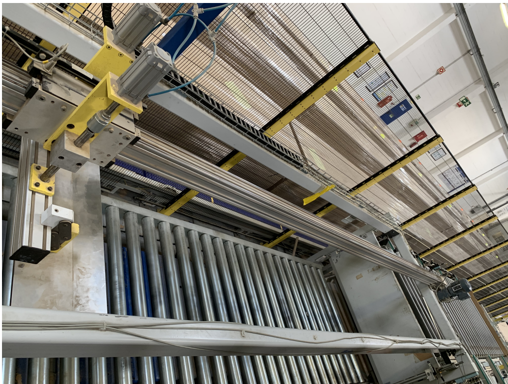
Figura 4.4: Mesa elevatória da Posição 41 e o respetivo empurrador de ripas Posição 42.
