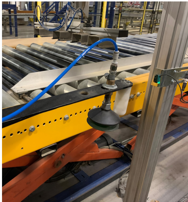
(a) Aplicação de uma almofada para amortecer a aproximação da ventosa
