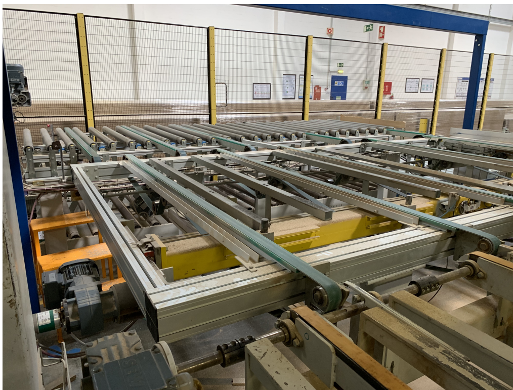
Figura 4.5: Sistema de transporte de ripas da Posição 43.
