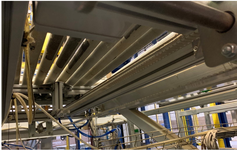
(a) Correias associadas ao veio do motor que movem o perfil que sustenta as pinças
