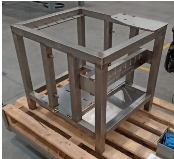
Figura 66 - Conjunto soldado da estrutura do protótipo
