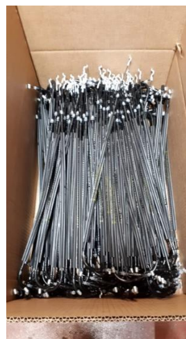
Figura 33 - Cabos de comando na caixa de produto final
