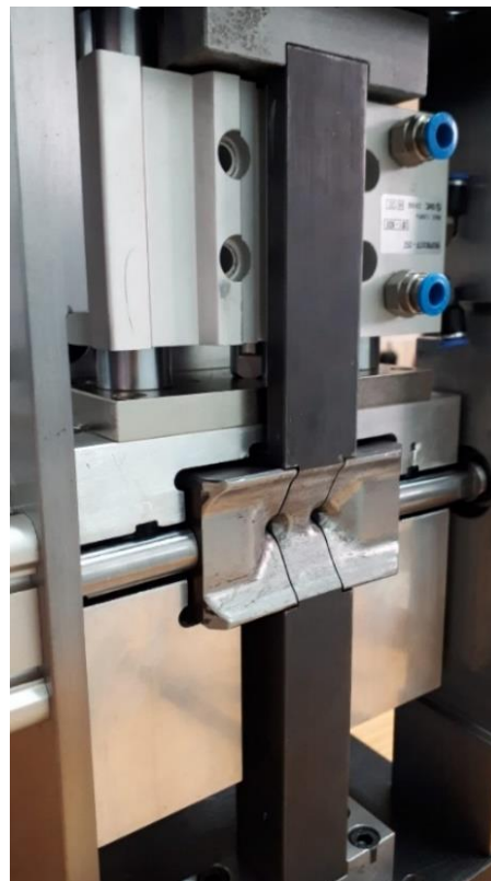
Figura 100 - Vista da parte frontal com o subconjunto das lâminas avançado até aos mordentes
