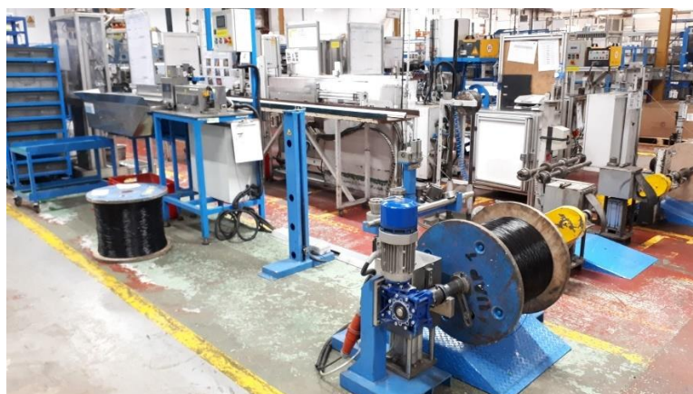
Figura 23 - Máquina de corte de cabo (UAP2)
