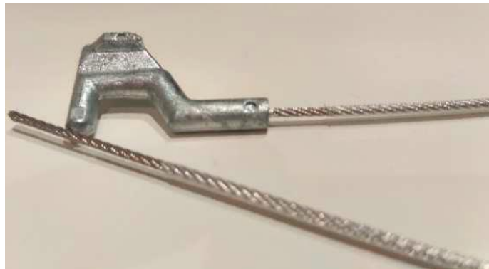
Figura 18 - Cabo após a injeção do terminal [59]
