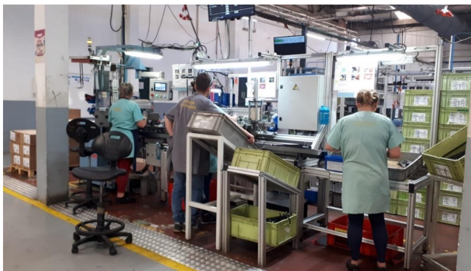
Figura 30 - Linha de montagem de cabos de comando JEEP
