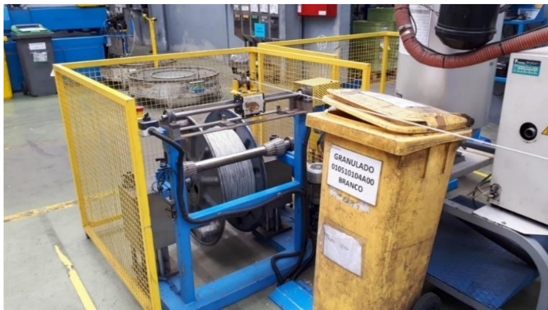
Figura 22 - Cabo revestido a ser enrolado em bobine após extrusão
