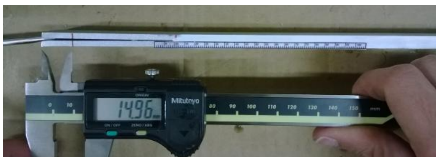
Figura 143 - Marcação de um dos pontos no provete ENF.
