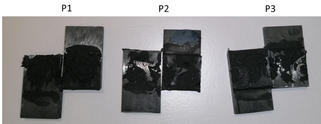
Figura 109 - Rotura dos provetes BS com 0 phr de concentração de fibras.
