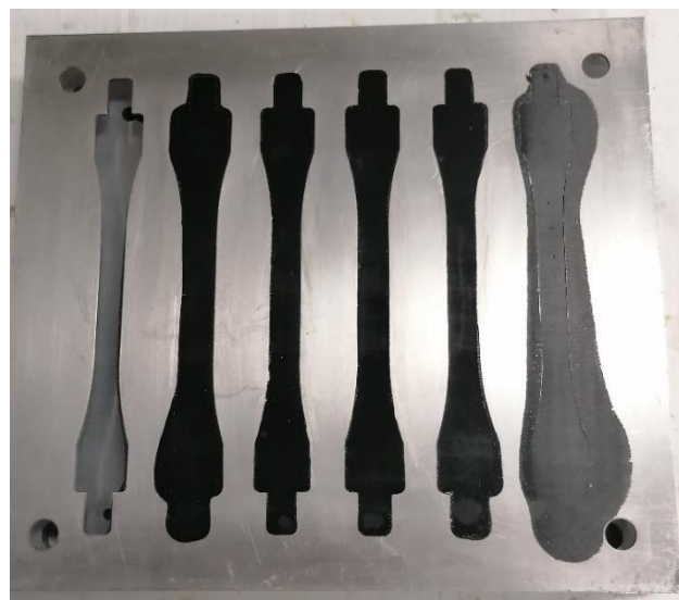
Figura 70 - Molde com os provetes após cura.
