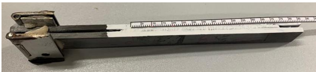
Figura 124 - Provetes DCB com escala milimétrica colada na lateral.
