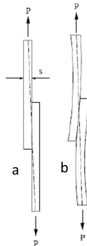
Figura 13 - Representação esquemática da flexão dos aderentes. Junta antes da deformação (a) deformação final da junta (b) [1].
