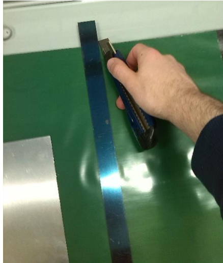
Figura 92 - Corte de camadas de pré-impregnado.
