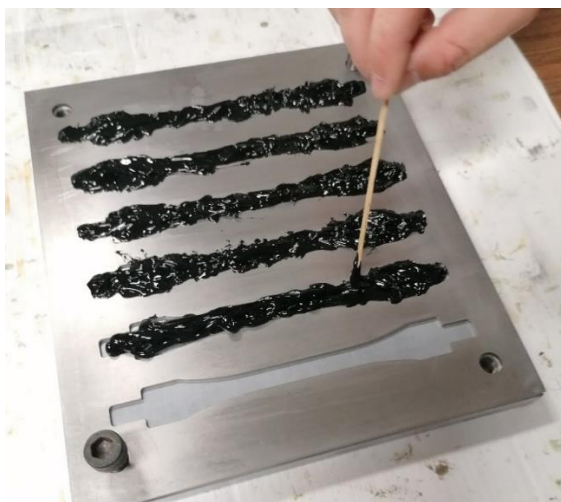
Figura 68 - Aplicação do adesivo com auxílio de uma espátula
