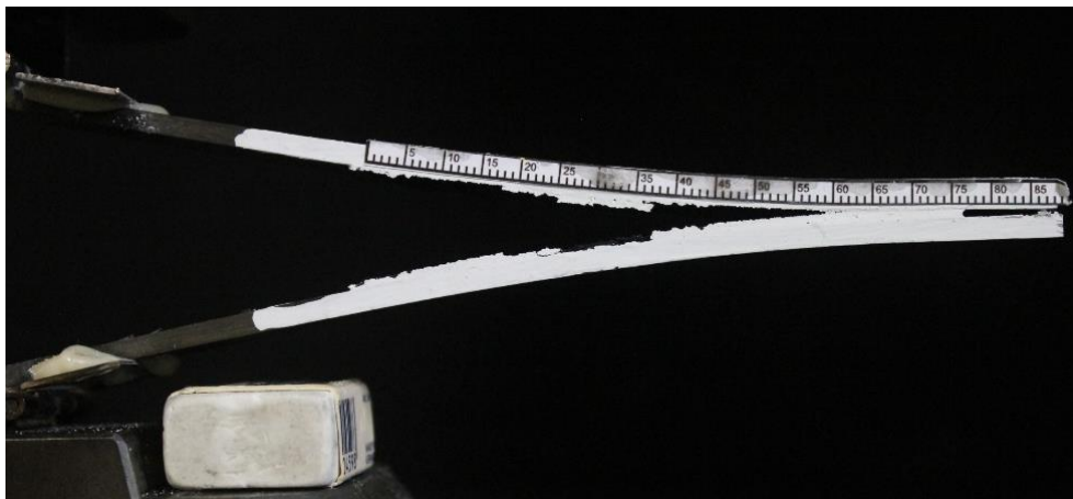
Figura 126 - Registo fotográfico durante o ensaio DCB momentos antes da rotura.
