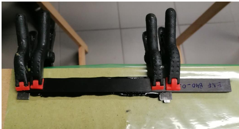
Figura 142 - Provete ENF com grampos para aplicação de pressão durante a cura.
