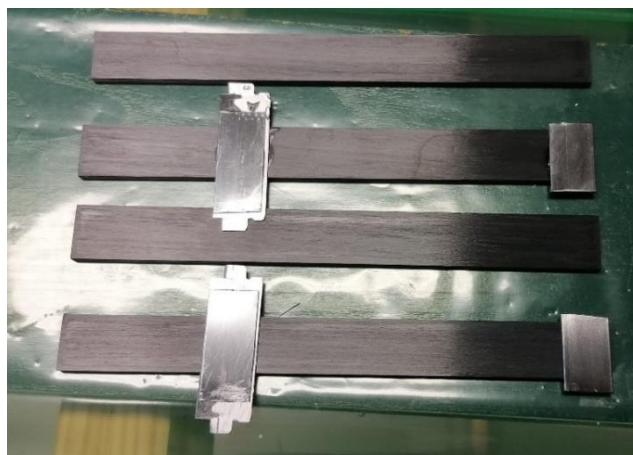
Figura 121 - Substratos DCB com calços.
