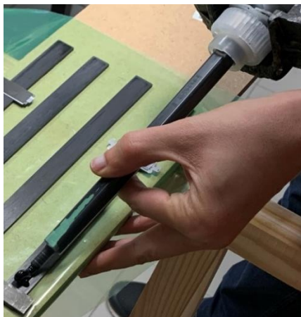
Figura 122 - Aplicação do adesivo com bico de mistura no provete.
