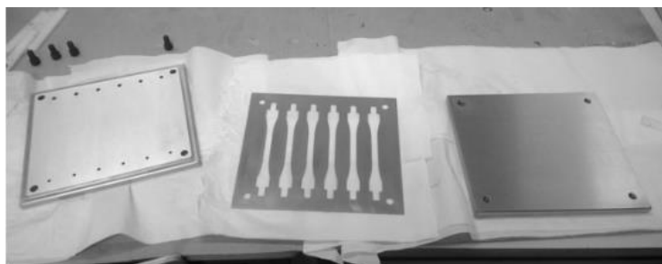
Figura 27 - Diferentes componentes no molde para produção de 6 provetes [21].
