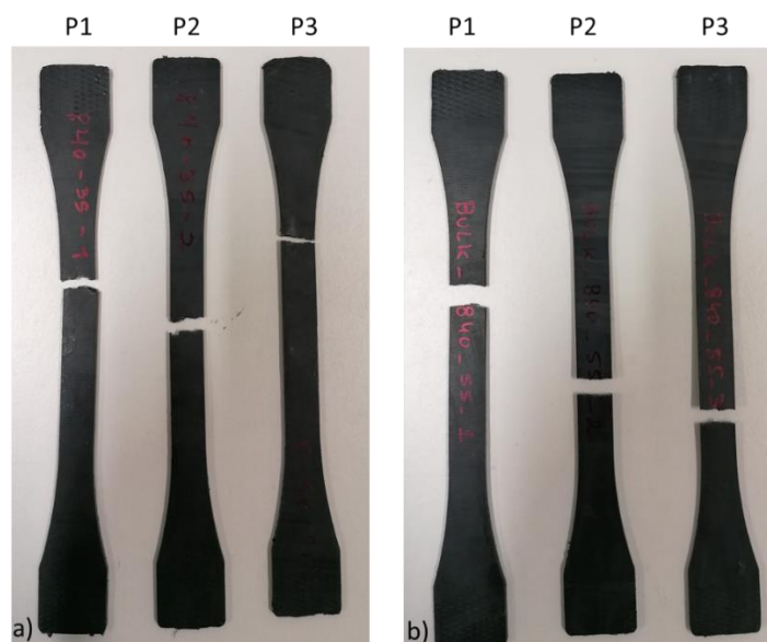
Figura 84 – Rotura dos provetes maciços: a) com 35 phr de concentração de fibras e b) com 55 phr de concentração de fibras.
