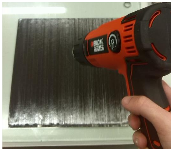
Figura 93 - Aplicação de calor nas camadas de pré-impregnado.
