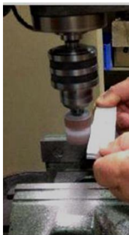
Figura 98 - Remoção do excesso de adesivo de um provete.
