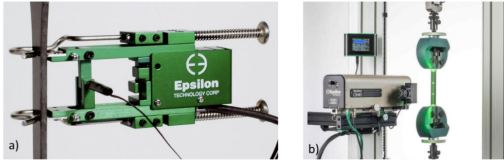
Figura 30 - Exemplo de extensômetro mecânico (a) e ótico (b) [24, 25].
