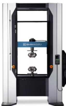
Figura 28 - Máquina de ensaios mecânicos Shimadzu [22].
