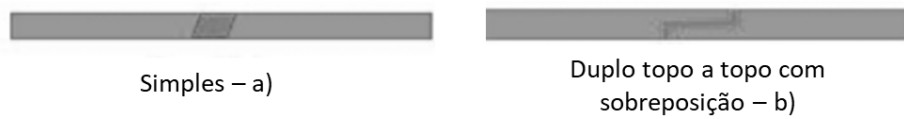
Figura 16 - Exemplo de juntas topo a topo simples a) e com sobreposição b) [13].
