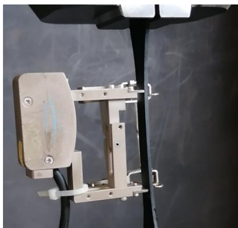
Figura 72 - Aplicação do extensómetro num provete de adesivo maciço.
