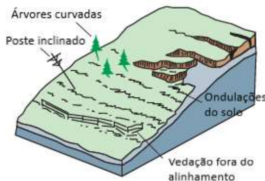
Figura 9 - Representação esquemática do creep (adaptado de Cruden & Varnes 2004).
