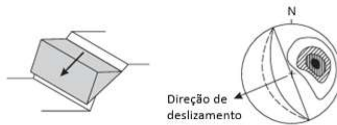
Figura 10 - Representação esquemática da rotura planar (a) e representação estereográfica típica dos planos de rotura planar (b) (adaptado de Wyllie & Mah 2005).
