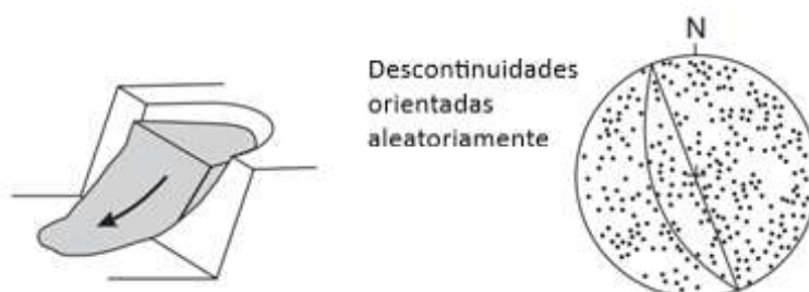
Figura 13 - Representação esquemática da rotura circular ou não plana (a) e representação estereográfica da rotura circular com uma distribuição aleatória de descontinuidades (b) (adaptado de Wyllie & Mah 2005).
