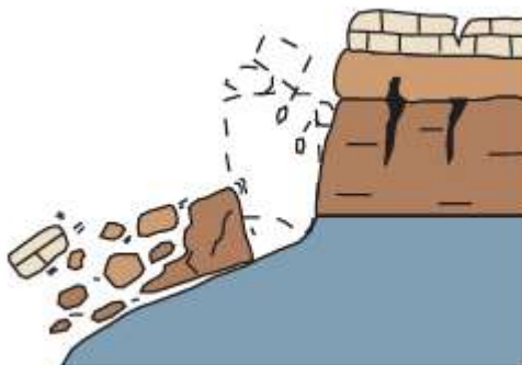
Figura 2 - Representação esquemática dos tombamentos (extraído de Cruden & Varnes 2004).
