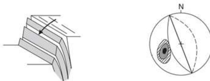
Figura 12 - Representação esquemática da rotura por toppling ou tombamento (a) e representação estereográfica típica dos planos de rotura por toppling ou tombamento (b) (adaptado de Wyllie & Mah 2005).
