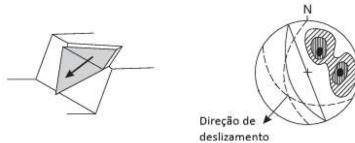
Figura 11 - Representação esquemática da rotura por cunha (a) e representação estereográfica típica dos planos de rotura por cunha (b) (adaptado de Wyllie & Mah 2005).
