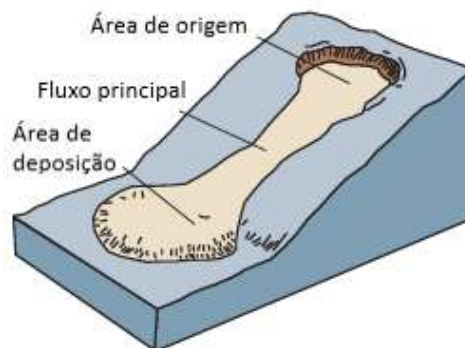
Figura 8 - Representação esquemática dos fluxos de terra e de lama (adaptado de Cruden & Varnes 2004).
