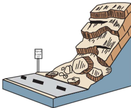
Figura 1 - Representação esquemática das quedas (extraído de Cruden & Varnes 2004).
