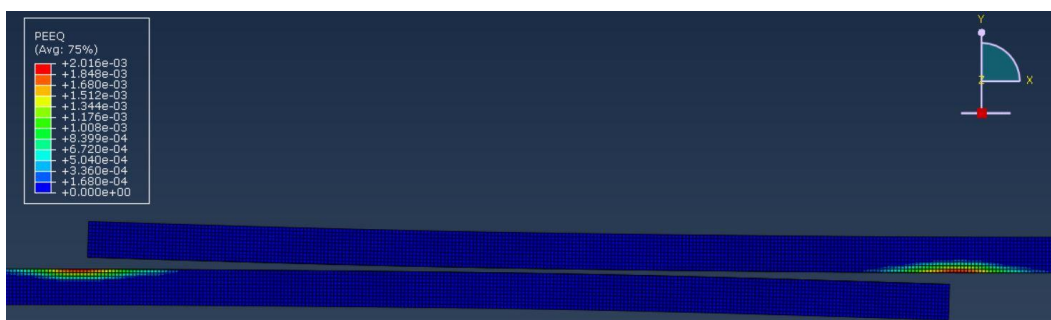
Figura 67. Deformação plástica com a combinação DP8005+XNR6852E-2 para L_0=50 mm
