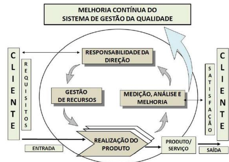
Figura 3 – Melhoria contínua do sistema de gestão da qualidade da norma ISO 9001 Fonte: Controle de Qualidade – Sistemas Normativos ISO 9001 e 14001; pág. 9, (Oliveira L. C., 2019)
