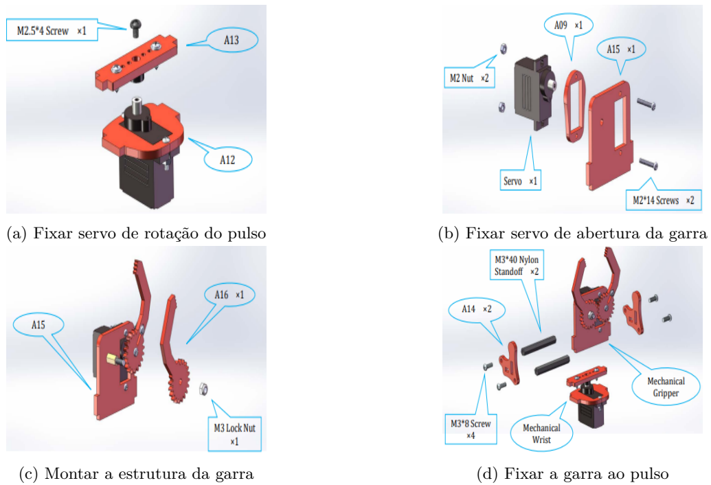
Figura 4.21: Montagem da garra
