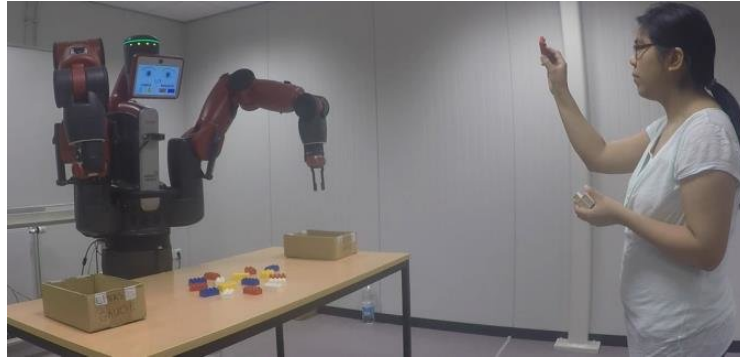
Figura 2.25: Exemplo de um cobot comandado por gestos [65]
