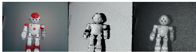
Figura 2.12: Vista de uma câmara RGB-D (da esquerda para a direita - imagem RGB, imagem de profundidade, imagem infravermelha com o padrão projetado) [18]
