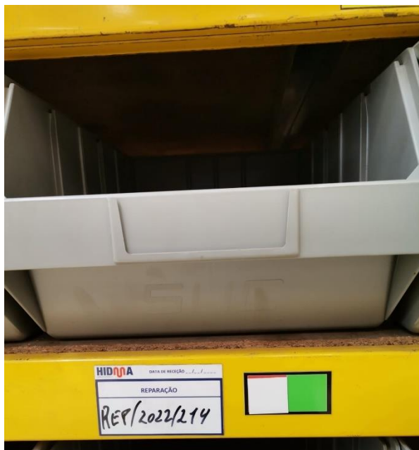
Figura 29 – Sinalética de identificação e sinalização do material para determinada reparação
