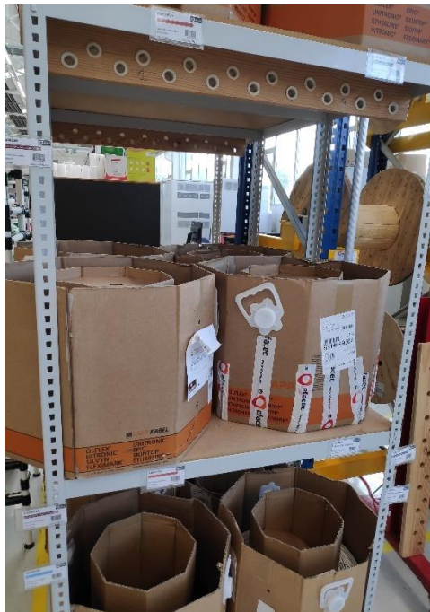
Figura 46 - Estante dedicada ao armazenamento dos conipacks .
