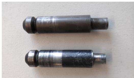
Figura 20 - Novo punção maquinado (em cima) e punção desgastado (em baixo).
