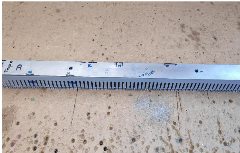
Figura 7 - Exemplo de gabari utilizado para executar a marcação das calhas.
