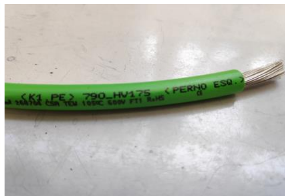
Figura 14 - Cabo com marcação e descarne.
