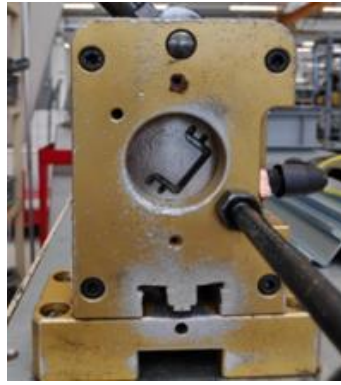
Figura 18 - Ferramenta com a guia desgastada.
