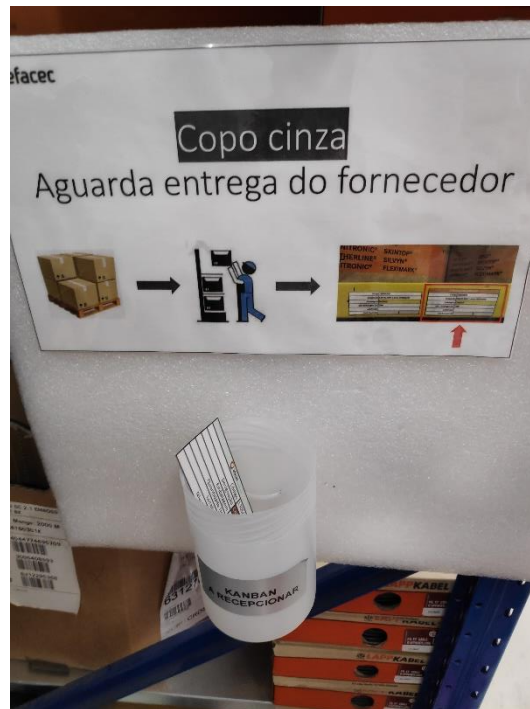
Figura 52 . Recipiente dedicado à receção de cablagem.
