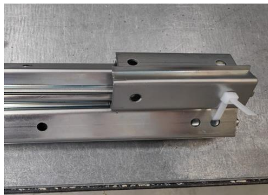
Figura 12 - União das calhas DIN através de uma abraçadeira plástica.
