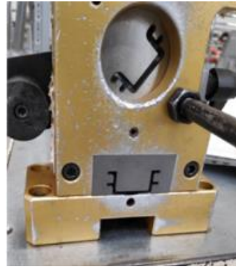
Figura 19 - Ferramenta com o postigo em aço nitruado.
