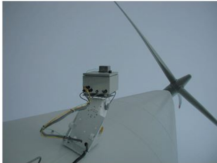
Figura 2.4: Exemplo de montagem vertical do sistema TADS [3] [4]
