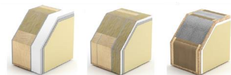
Figura 3 – Constituição de materiais em estruturas leves fabricadas [8]
