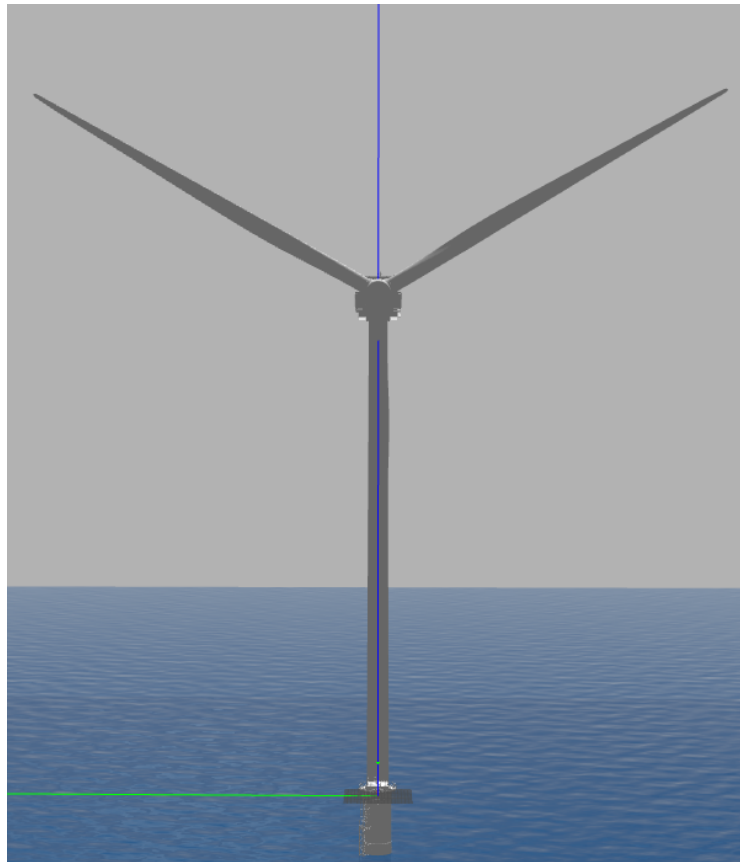
Figura 5.5: Configuração da turbina com offset de roll de 60° ( Y normal ), em que uma pá bloqueia parcialmente a torre, tornando a inspeção inviável.
