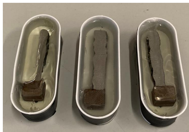
Figura 44 – Montagem final das secções transversais das deposições de paredes finas nos respetivos moldes
