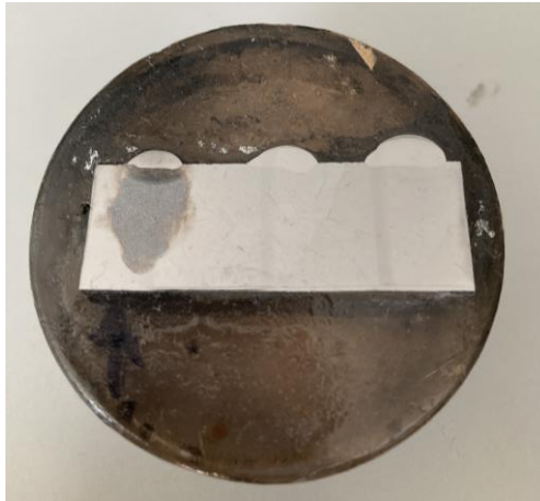
Figura 35 – Demonstração do ataque químico realizado no cordão e no material base
