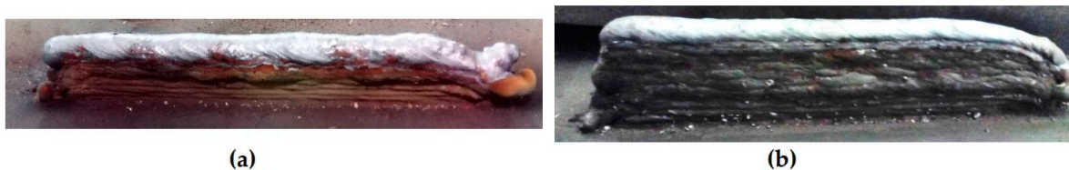
Figura 14 – Más formações na produção de uma deposição multicamada mantendo os parâmetros de impressão fixos (Adaptado de [47])
