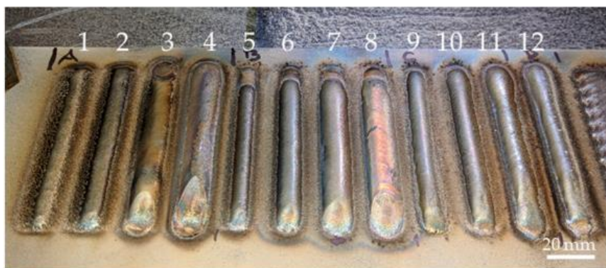
Figura 9 – Cordões realizados por Perez-Soriano et al. testando diversas configurações de parâmetros (Adaptado de [36])
