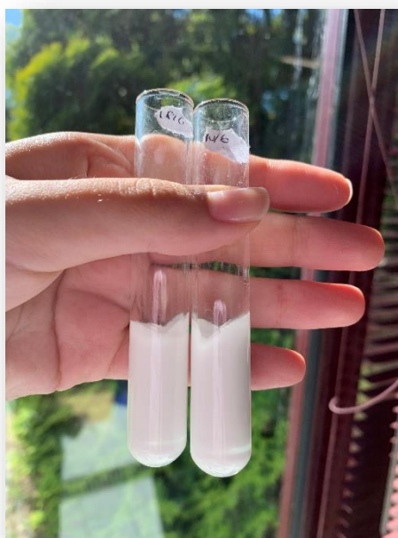
Figura 4. 15 – Comparação das estabilidades do fabrico e do ensaio C4 após serem submetidos a uma centrifugadora digital durante 15 minutos
