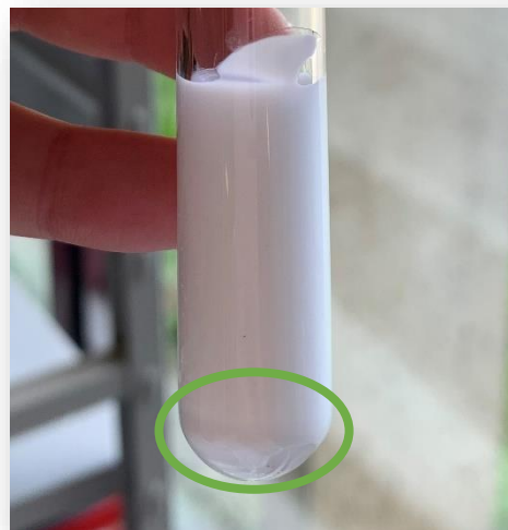
Figura 4. 14 – Estabilidade do fabrico ao fim de 15 min sujeito a uma centrifugadora digital
