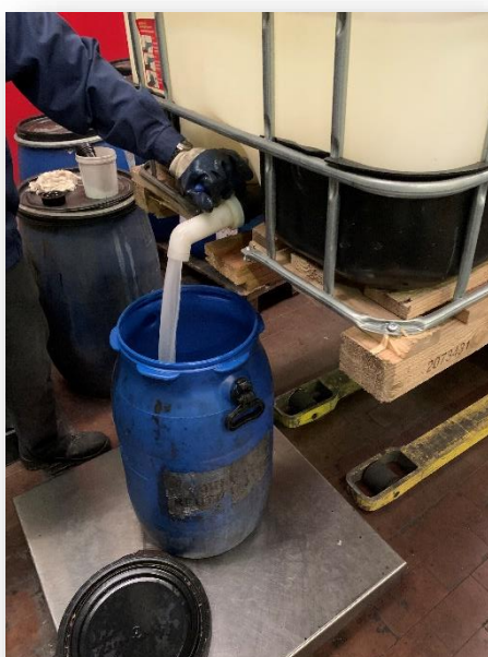
Figura 4. 6 - Pesagem do marlipal 31/90
