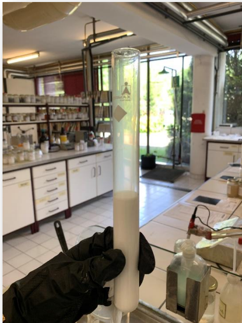
Figura 4. 11 - Emulsão obtida para a amostra de CQ do PA 2149
