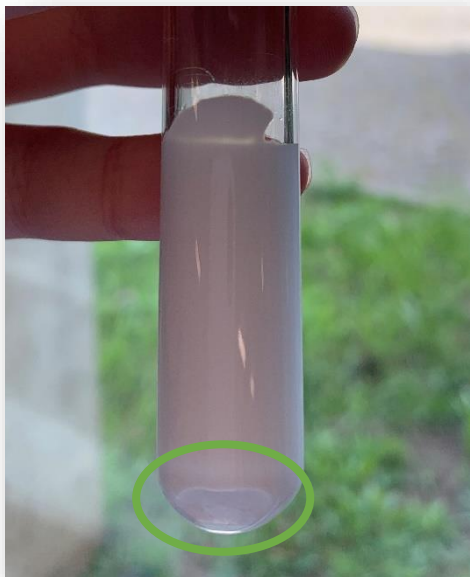
Figura 4. 13 - Estabilidade do ensaio B9 ao fim de 15 min sujeito a uma centrifugadora digital
