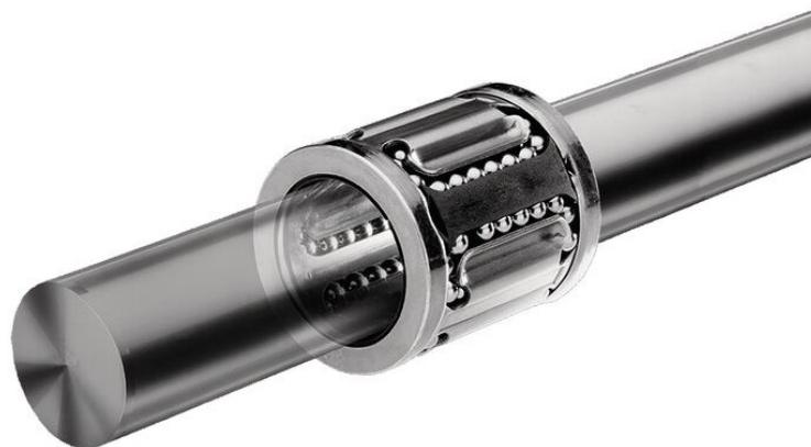
Figura 15 – Rolamento de esferas linear e veio de precisão para movimentos lineares [37]
