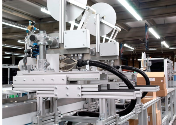
Figura 6 – Exemplo de estrutura em perfil de alumínio extrudido com rasgos para ligações aparafusadas rápidas [22]
