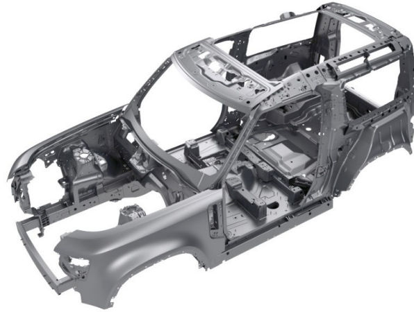
Figura 8 – Estrutura de um automóvel realizada por estampagem [25]
