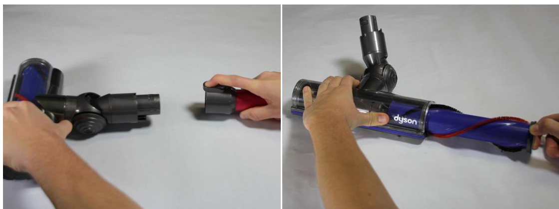
Figura 15 - Primeiros dois passos na reparação da cápsula na boca do aspirador Dyson V6
