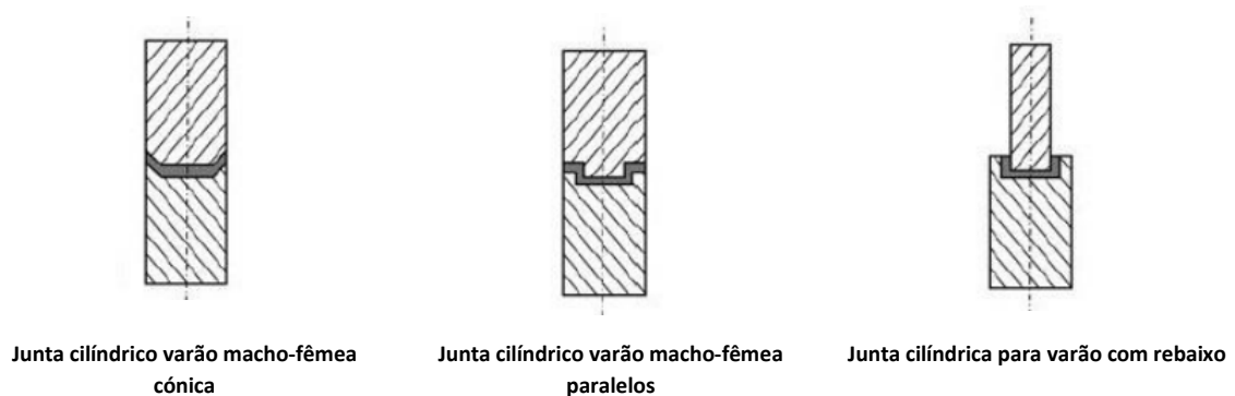
Figura 16 - Juntas cilíndricas em varões/veios [9].
