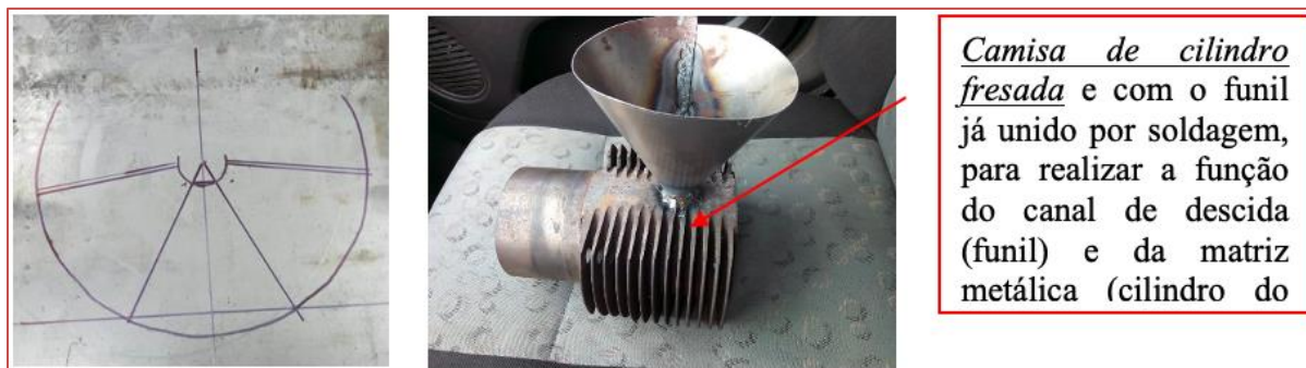
Figura 4 – Desenho da redução concêntrica (funil de descida) e na figura à direita, camisa do pistão com o funil acoplado.
