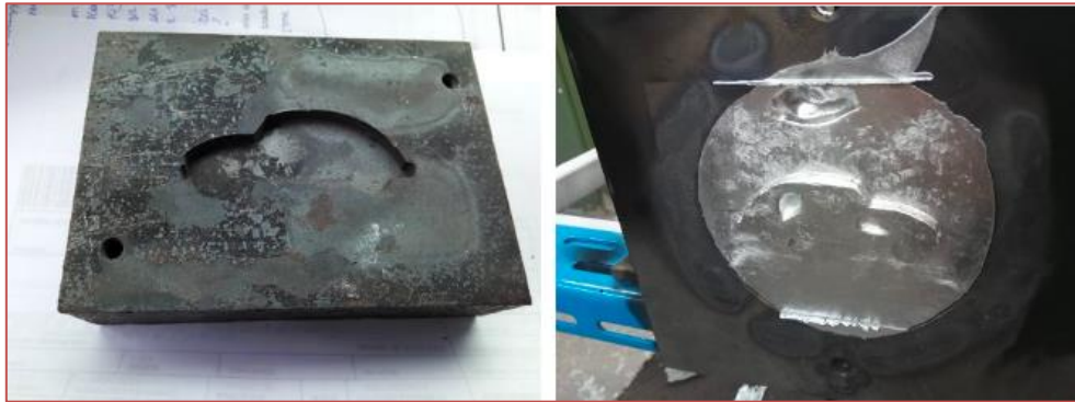
Figura 8 – Matriz metálica à esquerda. À direita, matriz preenchida com a liga escolhida para o desenvolvimento deste projeto
