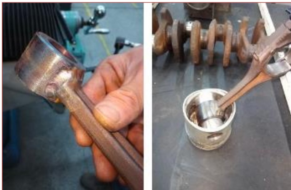
Figura 3 – Demonstração da adaptação da biela soldada na bucha usinada.
