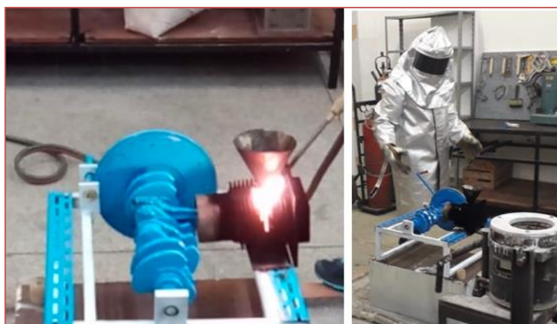
Figura 7 – Aquecimento do sistema de alimentação da injetora. À direita mostra equipamentos de proteção individual para os alunos envolvidos.
