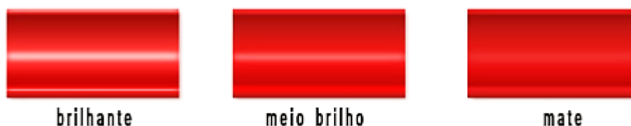
Figura 14 – Diferentes tipos de brilhos existentes numa tinta [21].
