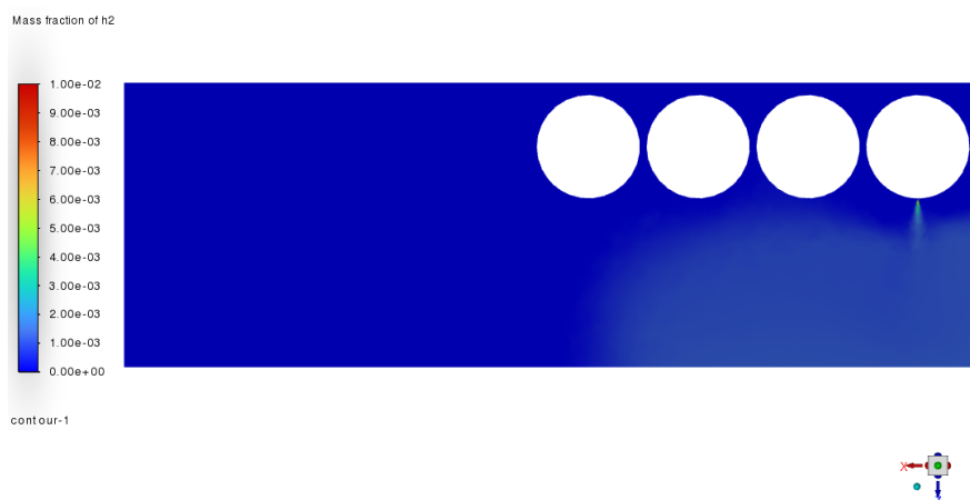
Figura 3.38: Corte horizontal (xz) à cota da fuga - Concentração média de H 2 – v2.0.
