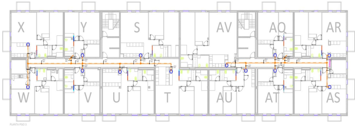
Figura 4.7 - Projeto AVAC - rede hidráulica AQS piso 3.
