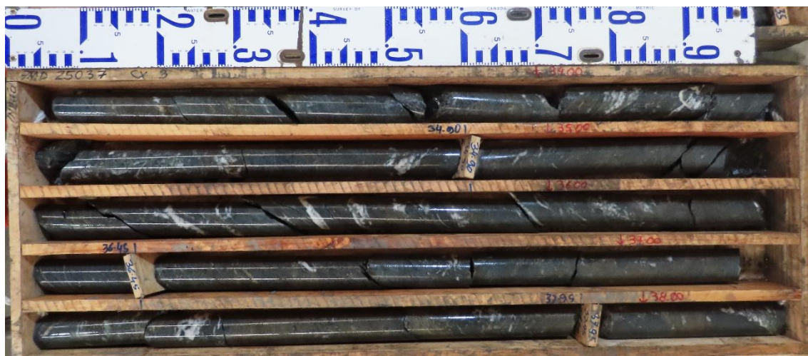
Figura 33 - Exemplo de testemunho de sondagem encaixotado de stockwork de fácies cuprífera (documentação interna Almina – Minas do Alentejo, S.A.).
