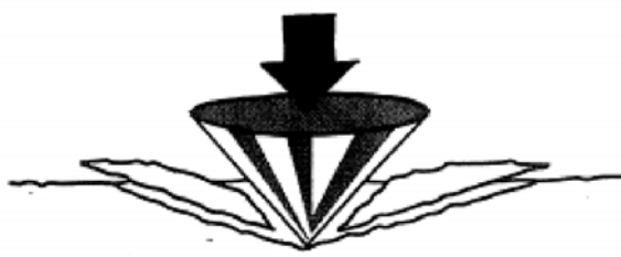
Figura 34 – Rocha submetida à acção de uma pressão elevada (Copco, 2004).
