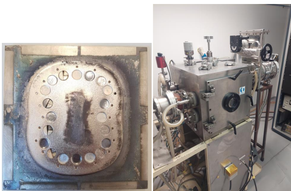
Figura 17 - Alvo de Ti com furos usado nas deposições e equipamento de deposição
