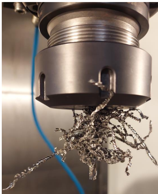
Figura 33 - Apara acumulada nas ferramentas
