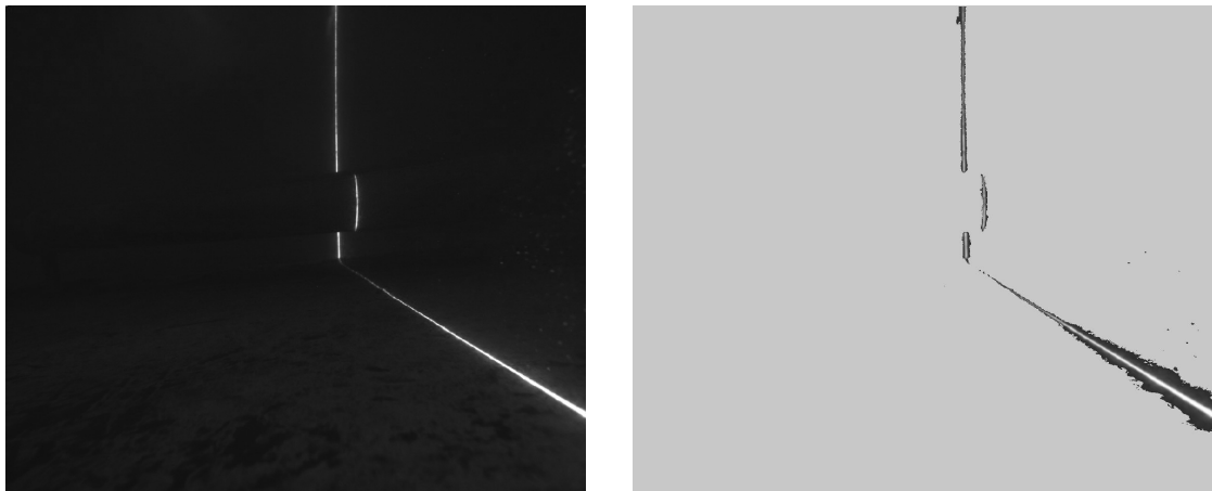
Figura 6.18: Imagens referentes ao antes e depois da aplicação do filtro gaussiano em torno dos pixels do laser.
