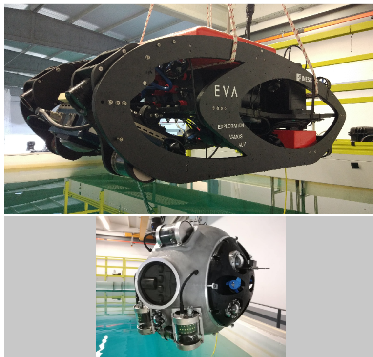
Figura 1.1: EVA e UX1. Veículos dos projetos VAMOS e Unexmin.
