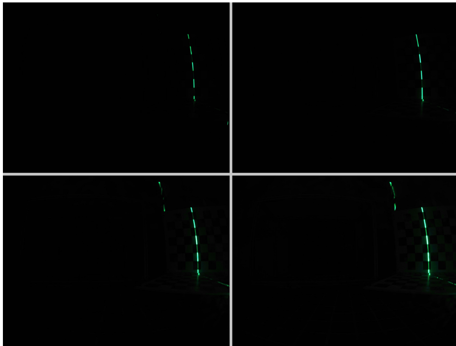
Figura 7.28: Imagens de laser em cada um dos scans , 2, 4, 10 e 15 ms, respectivamente.
