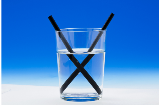
Figura 3.3: Ilusão ótica criada pela refração da luz.
