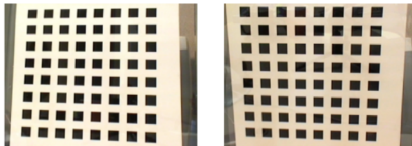
Figura 2.10: Padrão utilizado na calibração pelo método de Zhang [8].
