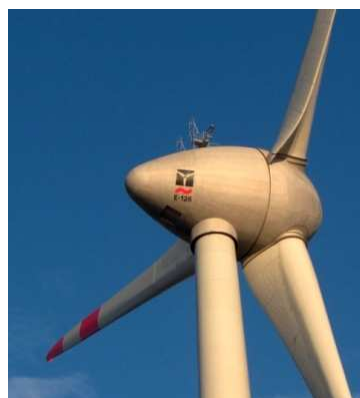
FIGURA 2.3 - REPRESENTAÇÃO DE UM AEROGERADOR EÓLICO DE EIXO HORIZONTAL [10]
