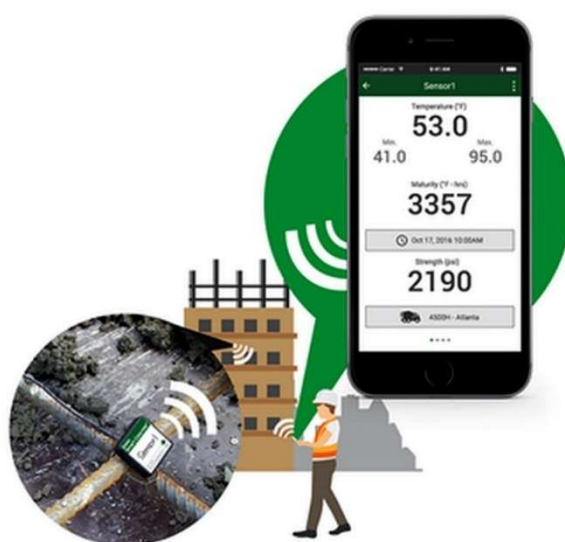
Figura 11 - Exemplo de digitalização da construção através do acompanhamento da cura do betão em tempo real que permite reduzir os tempos de descofragem assim como garantir a sua qualidade (Altair Santos, 2018)
